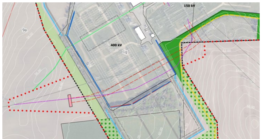
Figur 3-12 Tracé for styret underboring under eksisterende station fremgår med rød stiplede linje på dette zoom af stationskort i Figur 3-3.
