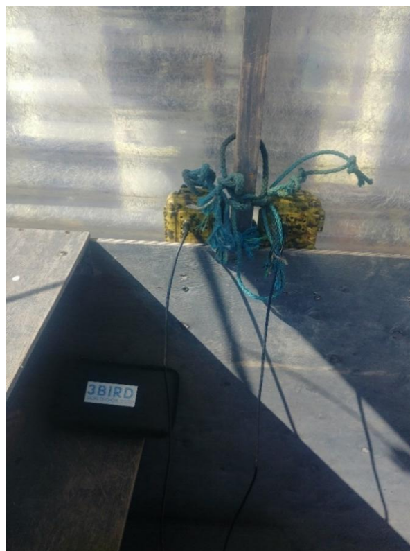
Figur 5: Placering af optagere udstyret med termometer og GPS-modtager
