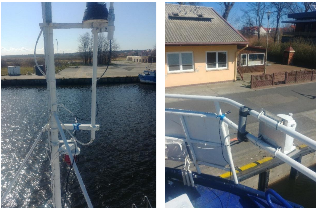
Figur 4: Placering og montering af ultralydsmikrofoner
