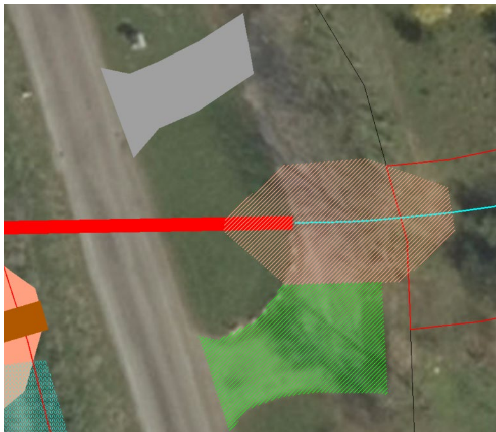
Figur 9 Arbejder ved indkørslen til Krumstrupvej 8. Grøn skravering: nuværende indkørsel fjernes, der udlægges muld og arealet tilsås. Okker skravering: skråning til rørdløb og nyt vandløb. Grå: ny indkørsel.
