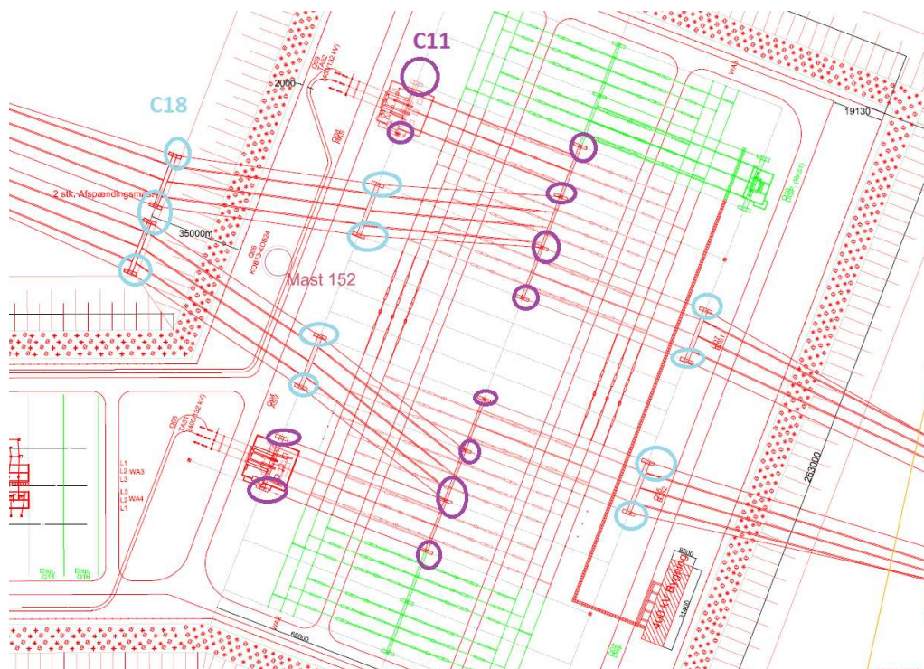
Figur 3.9. Markering af hvor eksisterende 400 kV luftledning indsløjfes på de nye station.
