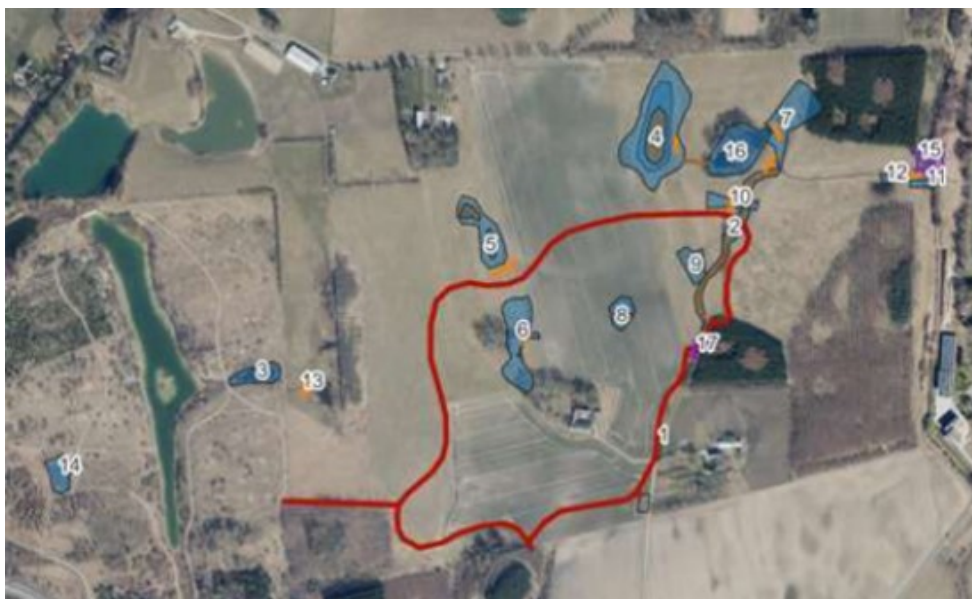
Figur 4. Udklip fra ansøgningsmaterialet. Den røde streg viser planlagte sti. Lilla markering viser planlagt bro over vandløb og de gule markeringer viser dræn. Udklippet er en oversigt over de planlagte hydrologitiltag. I det nyerehvervede skovrejsningsareal (projektet omfattet af screeningen) indgår indsatspunkterne 1, 2, 4, 5, 6, 7, 8, 9, 10, 16 og 17. De blå markeringer viser hvor meget vandstanden maksimalt vil stige ved en 100 mm nedbørshændelse uden afstrømning.
