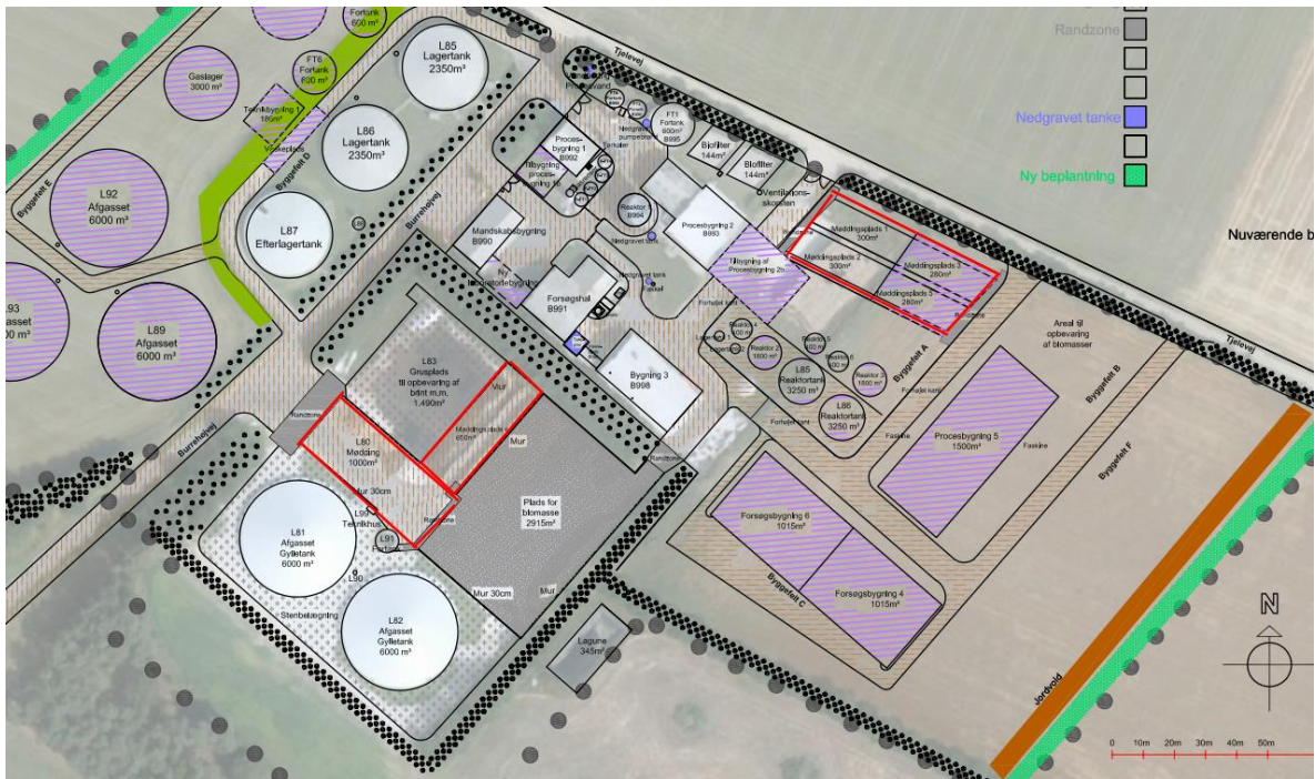
Billede 3. Planlagt projekt, placering af møddingspladser til opbevaring af dybstrøelse.
