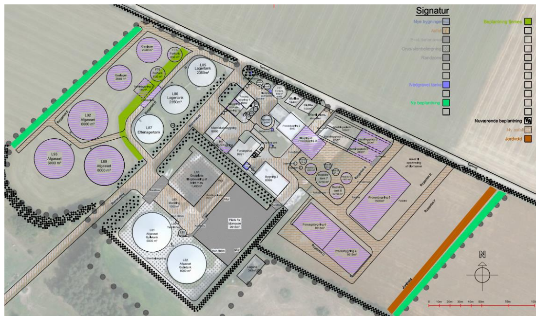
Fig. 1. Situationsplan for det udvidede biogasanlæg
