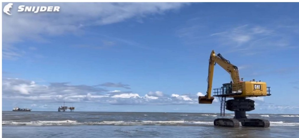
Figur 5.19. Eksempel på forhøjet gravemaskine til gravearbejde på lavt vand ( www.snijder.nl ).
