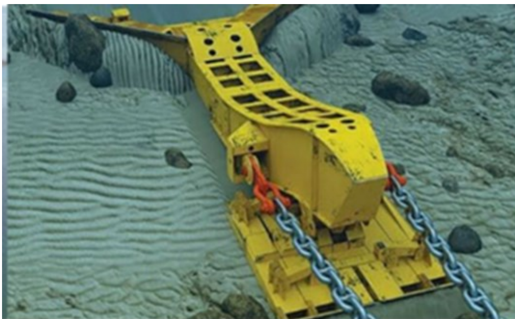
Figur 6.5. Eksempel på en SCAR boulder plough.
