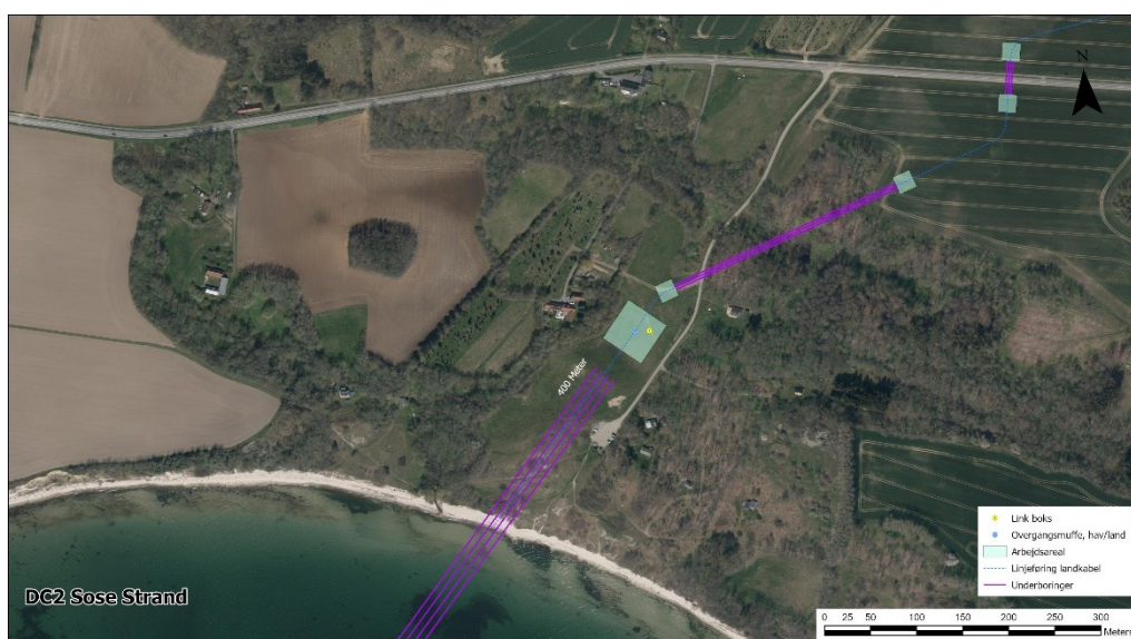
Figur 5.13. Illustration af placeringen af arbejdsarealerne inklusive udgravningsområde til TJB og styrede underboringer for ilandføringspunktet DC2 Sose Strand på Bornholm.
