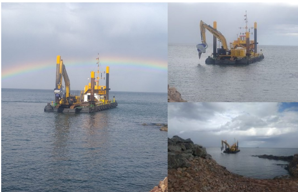
Figur 6.8. Eksempel på en gravemaskine på pram monteret med grubber.
