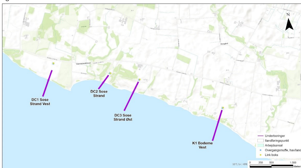
Figur 5.3. De fire ilandføringspunkter på Bornholms sydvestkyst, som ilandføres ved styrede underboringer af kysten: DC1 Sose strand Vest, DC2 Sose Strand og DC3 Sose Strand Øst og K1 Boderne Vest.
