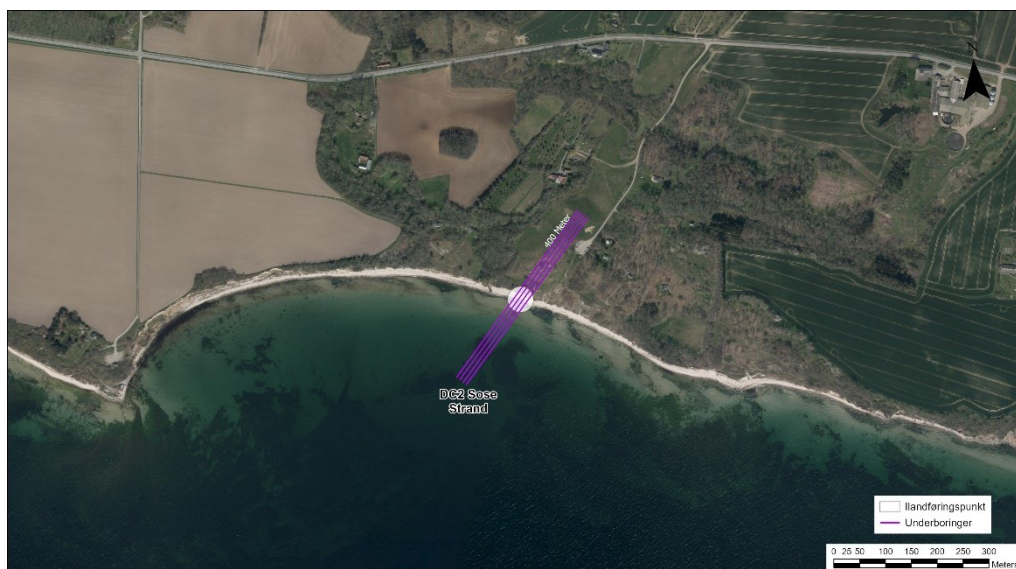
Figur 5.9. Ilandføringspunkt, DC2 Sose Strand. De lilla streger markerer placering og længde af de styrede underboringer.
