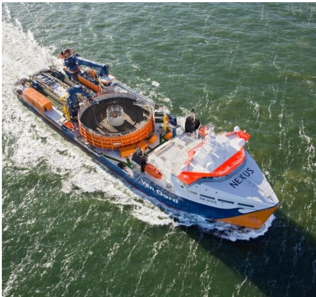
Figur 6.11. Eksempel på et moderne kabellægningsfartøj.
