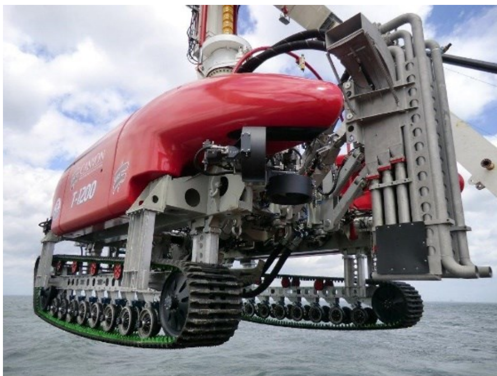
Figur 6.15. Eksempel på en moderne jetgraver T1200 (Primo Marine, 2022).
