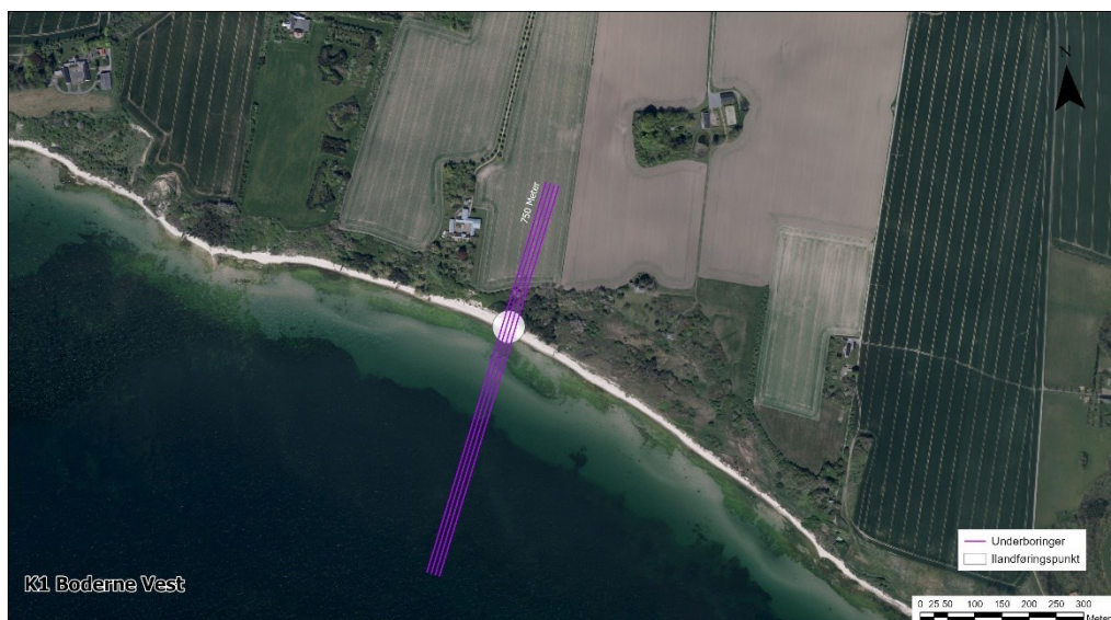
Figur 5.11. Koncessionsvindens ilandføringspunkt K1 Boderne Vest. De lilla streger markerer placering og længde af de styrede underboringer.
