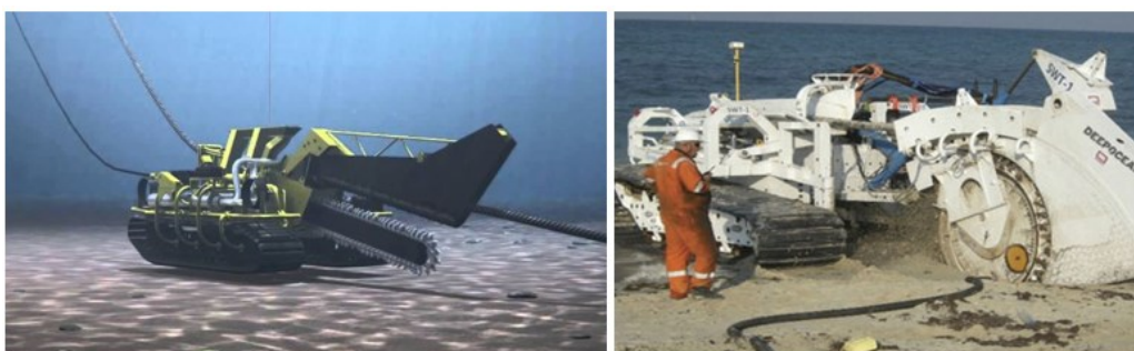
Figur 5.4. TV: Eksempel på mekanisk kædegraver. TH: Eksempel på mekanisk hjulgraver.
