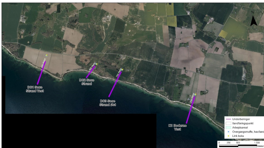
Figur 5.7. De fire ilandføringspunkter på Bornholms sydvestkyst. DC1 Sose strand Vest, DC2 Sose Strand og DC3 Sose Strand Øst og K1 Boderne Vest. De lilla streger markerer placering og længde af de styrede underboringer.
