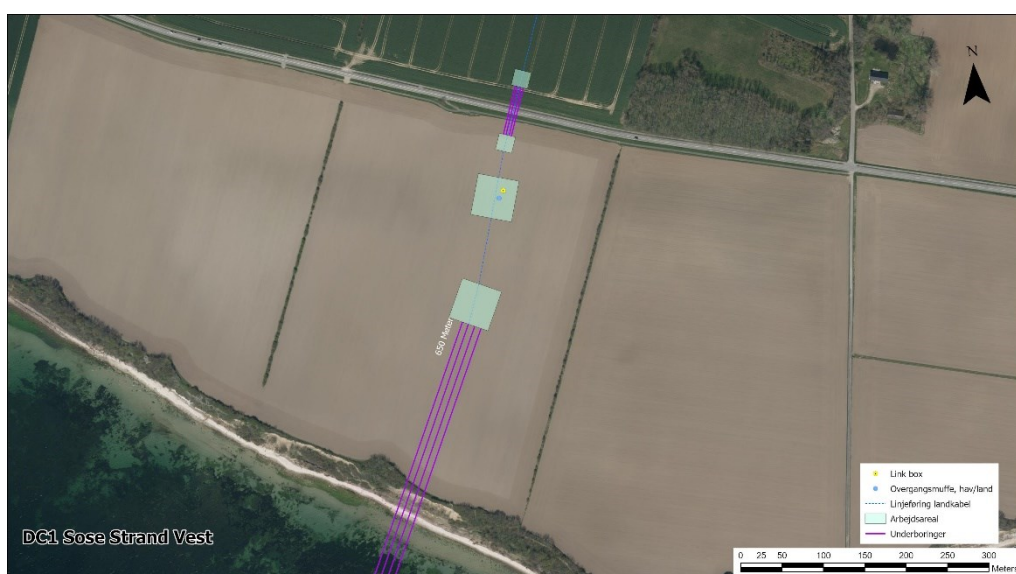
Figur 5.14. Illustration af placeringen af arbejdsarealerne inklusive udgravningsområde til TJB og styrede underboringer for ilandføringspunktet DC1 Sose Strand Vest, på Bornholm.
