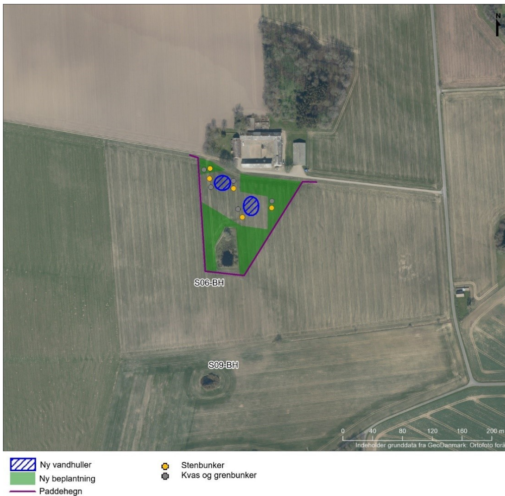
Figur 4.14. Kort over placering af erstatningsnatur for vandhul S09-BH som nedlægges i anlægsfasen for at give plads til den nye højspændingsstation. Der etableres ny beplantning i erstatningsarealet som bliver afgrænset af et paddehegn ligeledes i anlægsfasen. Beboelsesejendommen "Soldatergården" ligger nord for vandhullerne.
