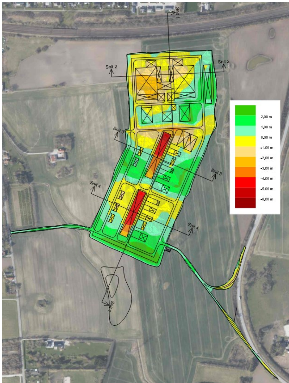
Figur 4.22. IsoPach plan for site layout - røde og orange farver viser afgravning og grønne farver viser påfyldning.
