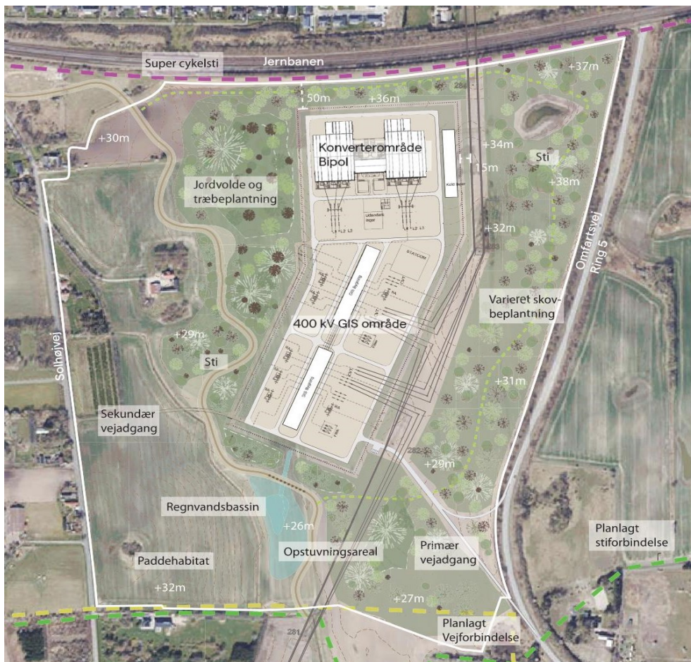
Figur 4.23. Skitseplan for indretningen af stationsanlægget ved Solhøj.
