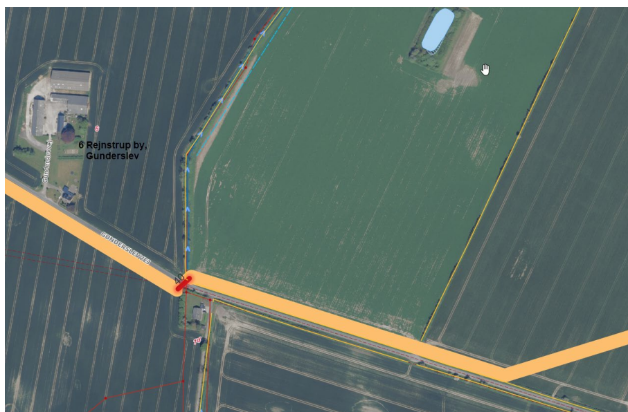
Figur 43 -Kortudsnit som viser projektets krydsning af et rørlagt vandløb (UB40). Pilene viser vandstrømningens retning
