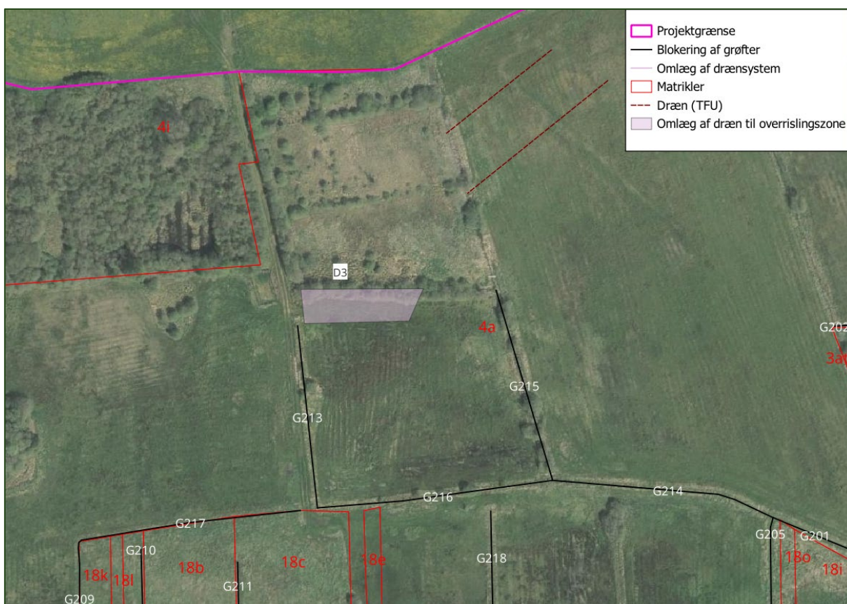
Figur 26, Kortskitse over omlægningen af drænsystem D3.
