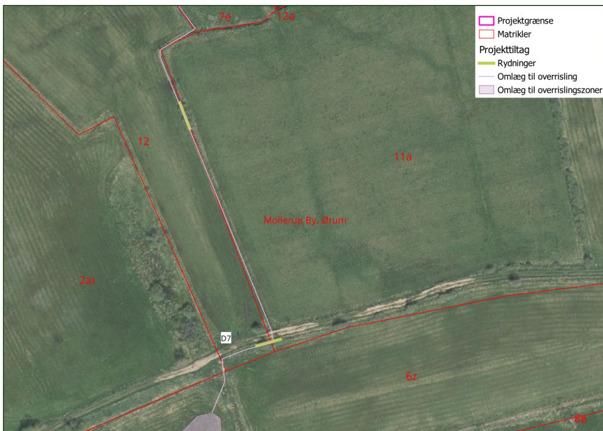
Figur 33. Oversigtlig angivelse af 2 strækninger/områder, hvor der ryddes i forbindelse med omlægning af drænsystem D7. Der skal foretages rydninger af løvbuske i forskellige størrelser. Samlet forventes ryddet ca. 30 m.
