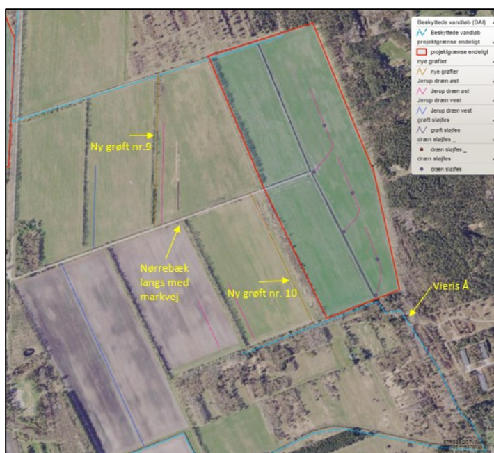
Figur 4-13. For markarealerne beliggende mellem de to delområder sikres drænforhold opretholdt ved etablering af to grøfter vist på kortet. Fra nord kan vandet afledes via ny grøft til Nørrebæk og videre via ny grøft til Vieris Å. Kortudklip fra miljøgis.
