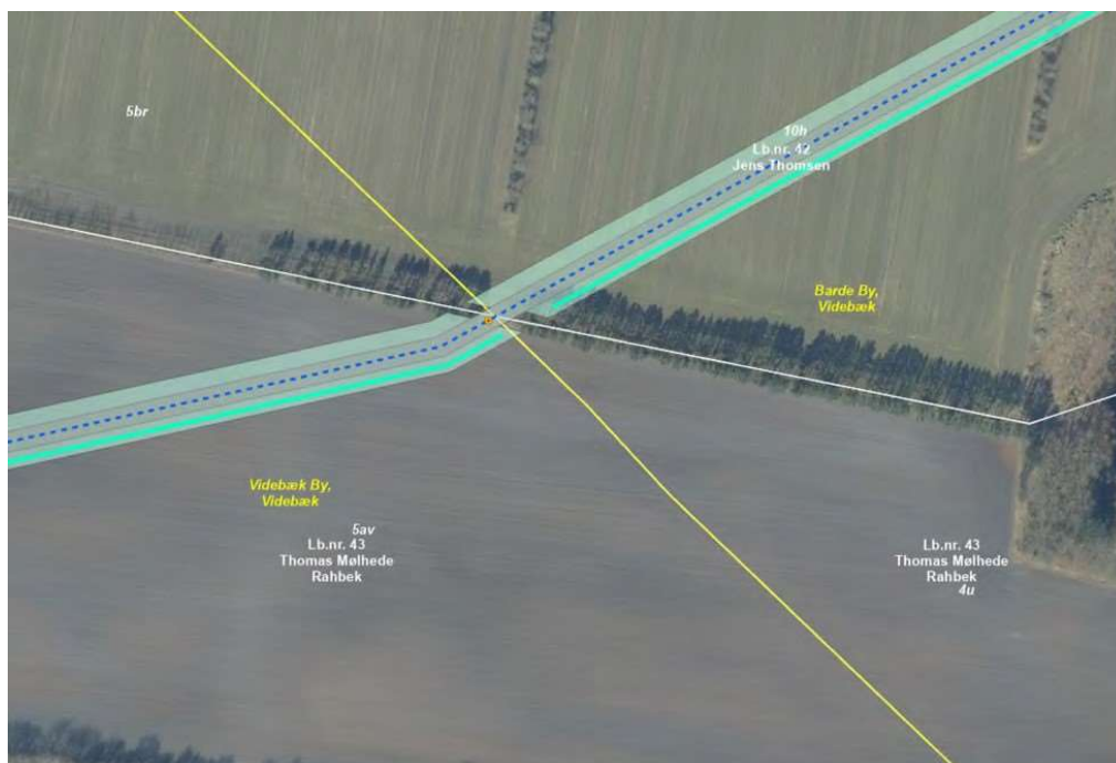
Figur 2-8 Indsnævret arbejdsbælte ved matr. 10h Barde By, Videbæk
