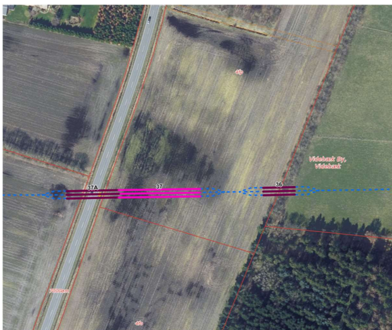
Figur 2-7A: Rørlægning af kommende vejanlæg.
