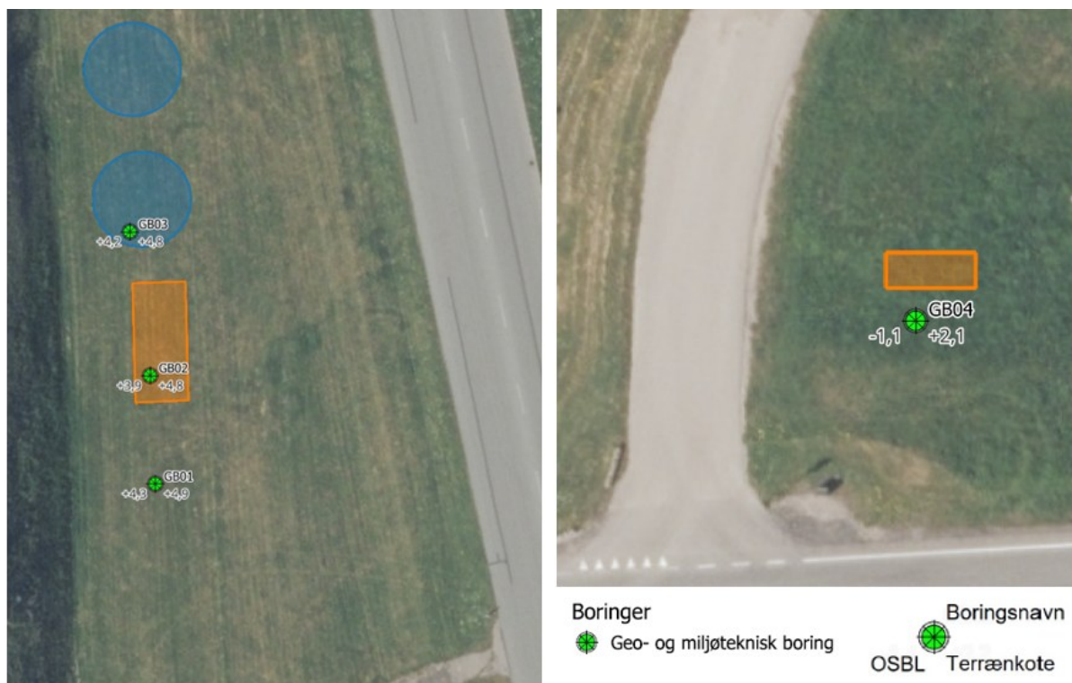
Figur 10. Venstre: placering af 3 geo- og miljøtekniske borer for delområde 1, hvor der etableres et vandreservoir (blå) og et teknikhus (orange). Det bemærkes, at placeringerne er blevet ændret siden borerne blev placeret. Højre: placering af 1 geo- og miljøteknisk boring for delområde 2, hvor der etableres en trykforøgerstation (orange). Kilde: bygherre (modificeret).
