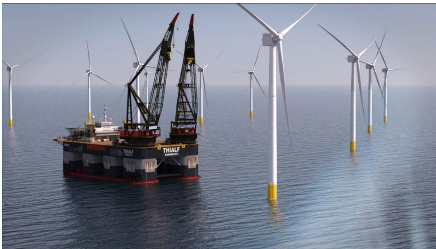
Figur 4.1. Exempel på kranplattform som används för installation av TLP-plattformar för offshoreindustri och som skulle kunna användas för installation av flytande fundament och montering av vindkraftsturbiner (Heerema).
