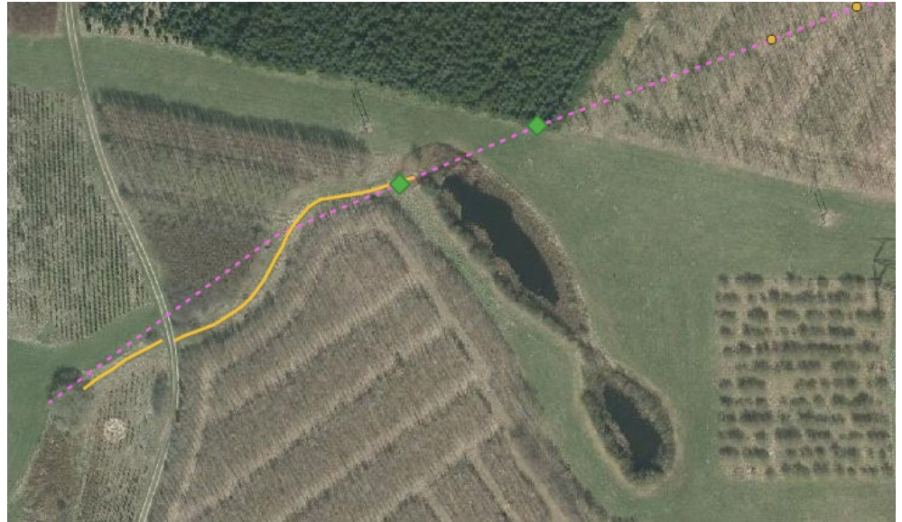
Figur 3: Eksisterende forhold omkring søen i projektområdet. Stiplet linje er forventet forløb af drænedningen og gul linje er eksisterende grøft. Med orange er angivet forventet placering af brønde men de grønne firkanter angiver drænedningen som fundet ved fri-gravning hhv. nord (opstrøms) og vest (nedstrøms) for søen.
