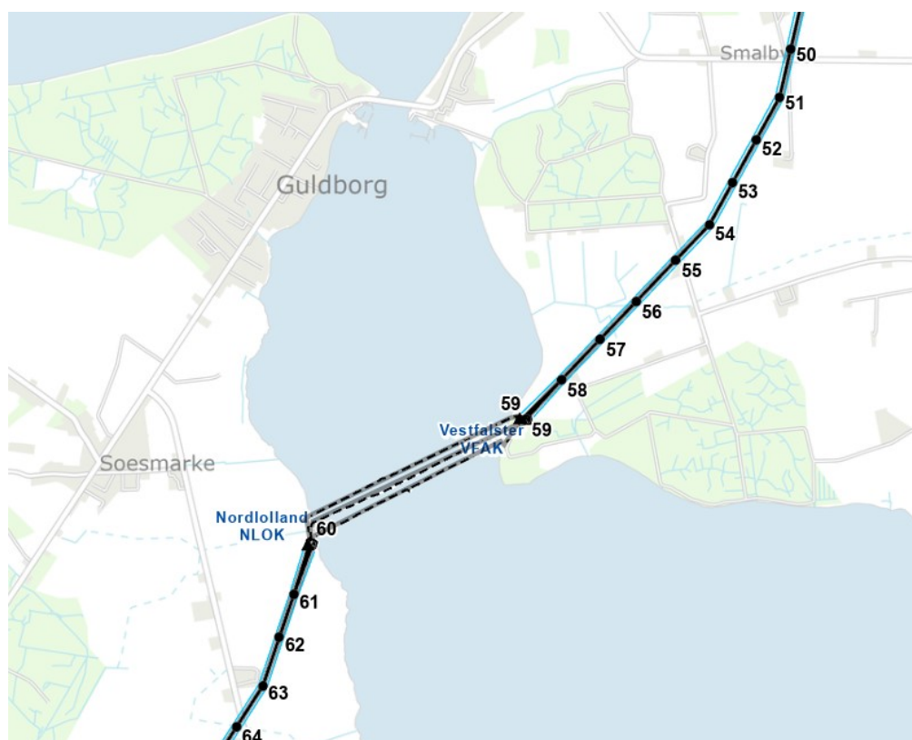
Figur 1-2 Kabelovergangsstationer på Lolland og Falster nedtages som led i saneringsprojektet.
