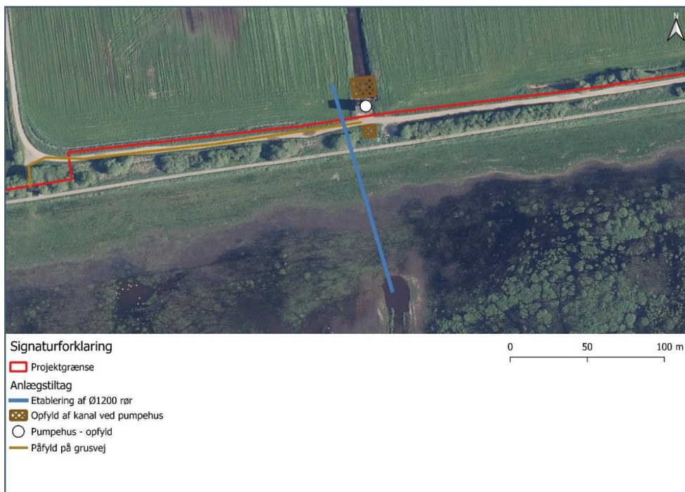
Figur 1.5 Anlægstiltag ved pumpehuset.
