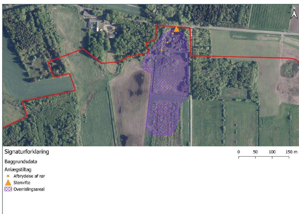
Figur 1.7 Afbryde rørlægning og etablere overrisling af eng. Den orange pil peger på Ånumvej.
