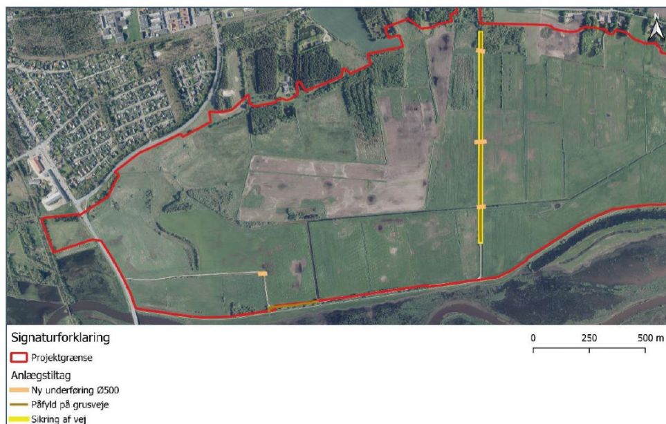
Figur 1.8 Sikring af grusveje og vandpassage gennem tre vejunderføringer.
