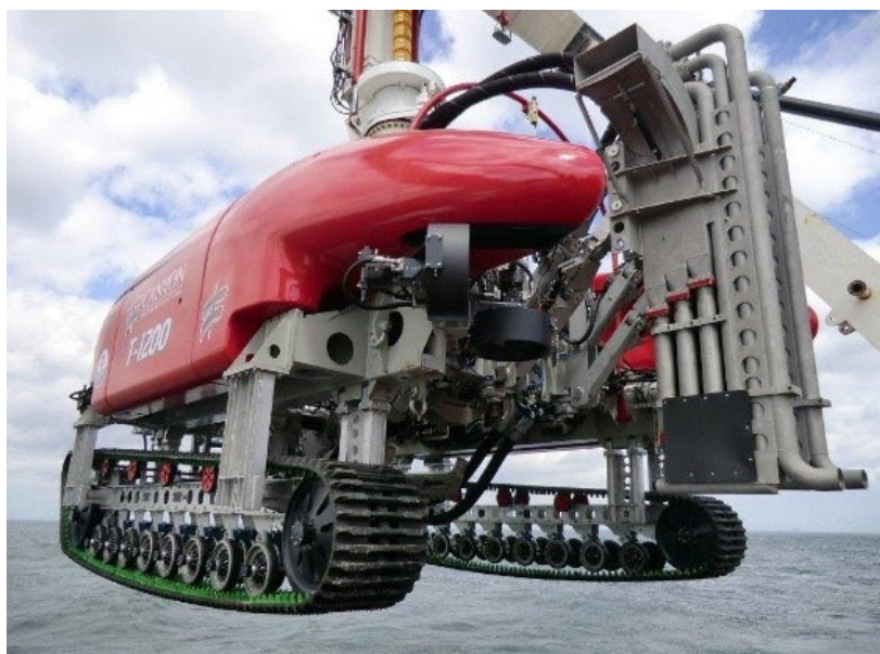
Figur 2-3: Eksempel på en moderne jetgraver T1200 (Primo Marine, 2022)
