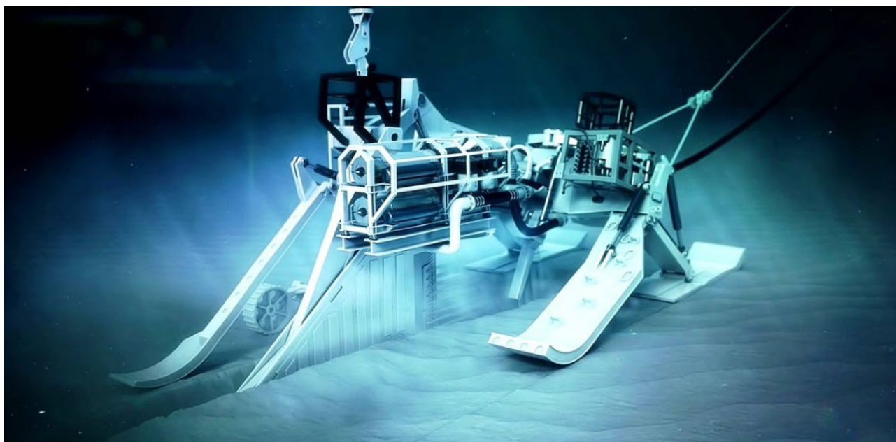
Figur 2-4: Eksempel på en marin plov med monteret jetter (spuledysers) for at nedbringe de nød-vendige træk-kræfter for nedgravningen (Primo Marine, 2022).
