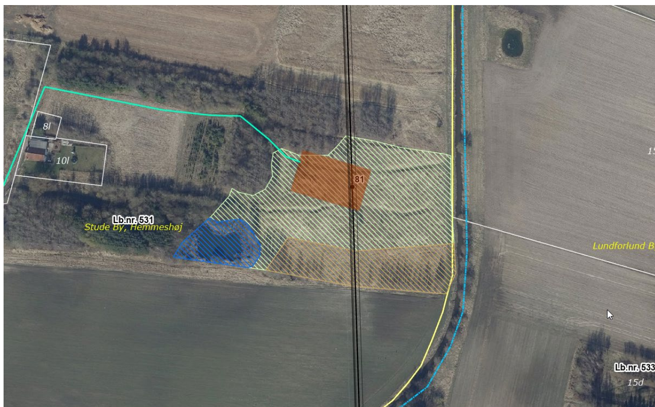
Figur 7–6 Mast nr. 81 beliggende i beskyttet natur i form af eng. Engarealet er vist med grøn skravering. Midlertidige arbejdsarealer er markeret med brun og midlertidige adgangsveje med grøn.
