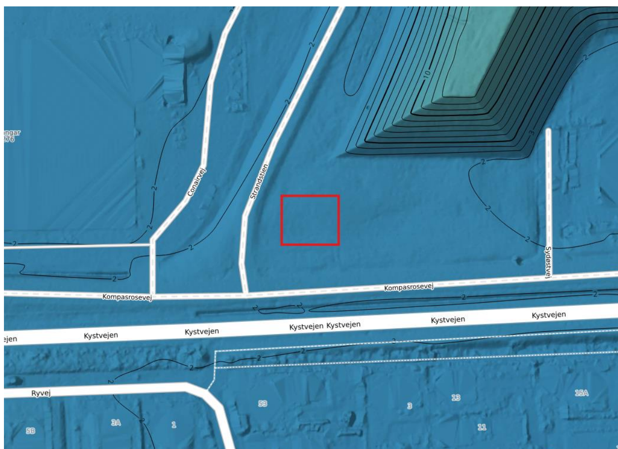
Figur 3-1 Terrænkort med højdekurver, hvor projektområde "Ny Syd trykforøger" er markeret med rød. I højre side ses den 10 meter høje vold. Kilde Danmarks højdemodel, via Scalgo.LIVE.dk
