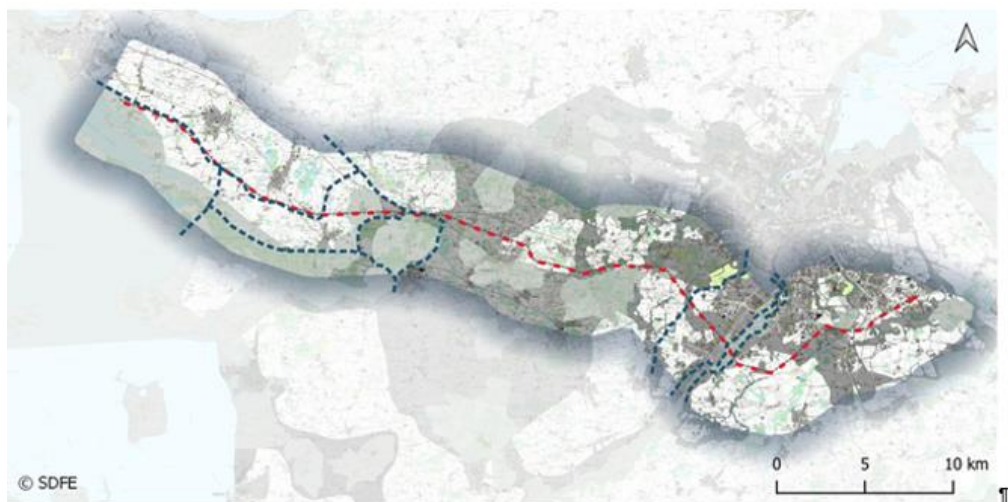
Figur 14. Udpegede landskabsinteresser omfatter (lys grøn flade) bevaringsværdige landskaber og (brun/grå flade) større sammenhængende landskaber. (Rød stiplede linje) 400 kV-luftledningsanlægget mellem Kauslunde i vest og Fraugde i øst.
