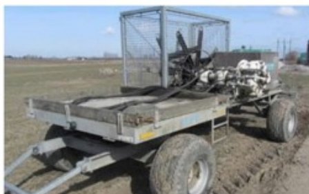
Billede 4.1 Maskine til at rulle demonterede ledninger op
