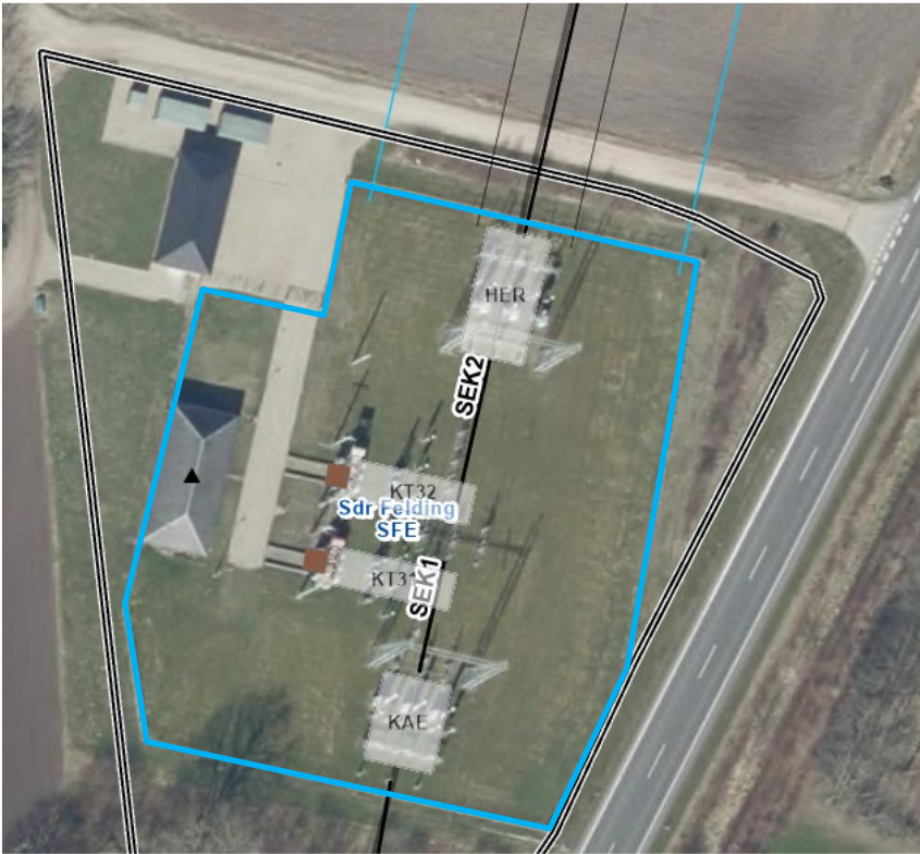
Figur 2.2. Eksisterende 150 kV og 10 kV-station Sønder Felding (SFE).
