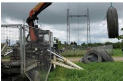
Billede 4.1 Maskine til at rulle demonterede ledninger op
