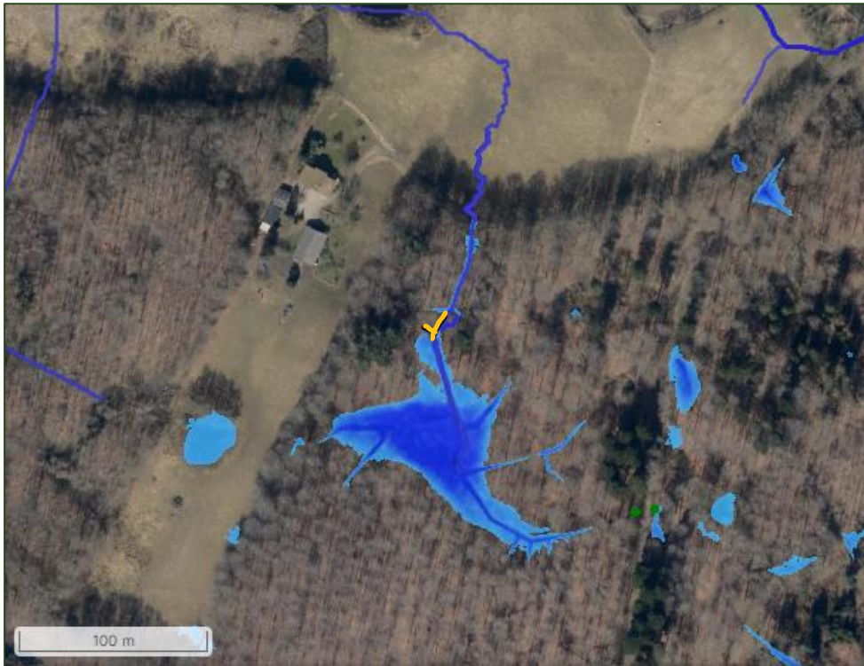
Figur 3.3 b H1, effektområde ved en regnhændelse på 100 mm for at vise områdets robusthed. Grøften mod nord tilkastes. Her afbilledet med en gul streg. Billedet er fra SCALGO.
