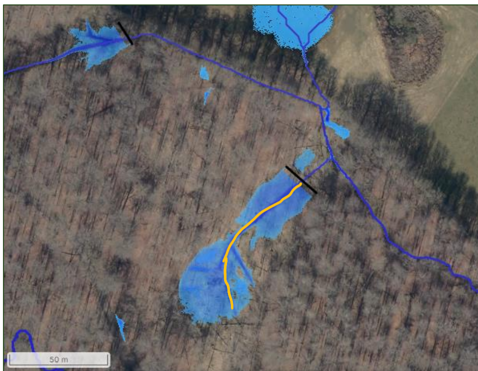
Figur 3.9 H4, hvor den centrale grøft lukkes. Figuren viser en visualisering af det hydrologiske effektområde ved skybrud. 100 meter grøft bliver fyldt med jord, gul streg.
