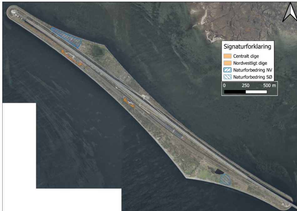
Figur 2. Placering af stormflodssikring (angivet med gult) samt det nordvestlige og sydøstlige afgravningsområde (angivet med blå).
