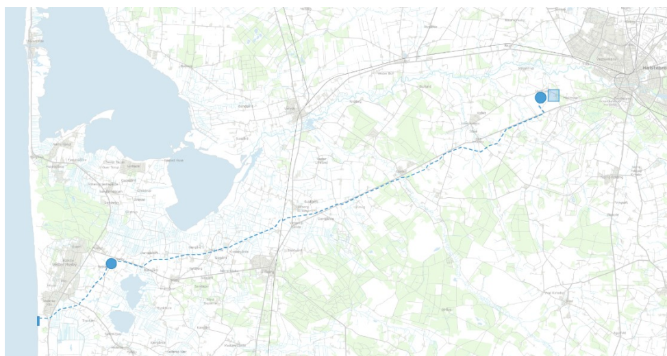
Figur 1 Placering af projektet Nordsøen I – A3 Vedersø Klit til Idomlund, hvor firkanten angiver placering af ilandføringspunktet, cirklerne angiver placering af anlæg (vest: kompensationsstation, øst: koblingsstation) og trekanten angiver placering af eksisterende højspændingsstation ved Idomlund. Den stiplede linje angiver placering af landkabeltracé.
