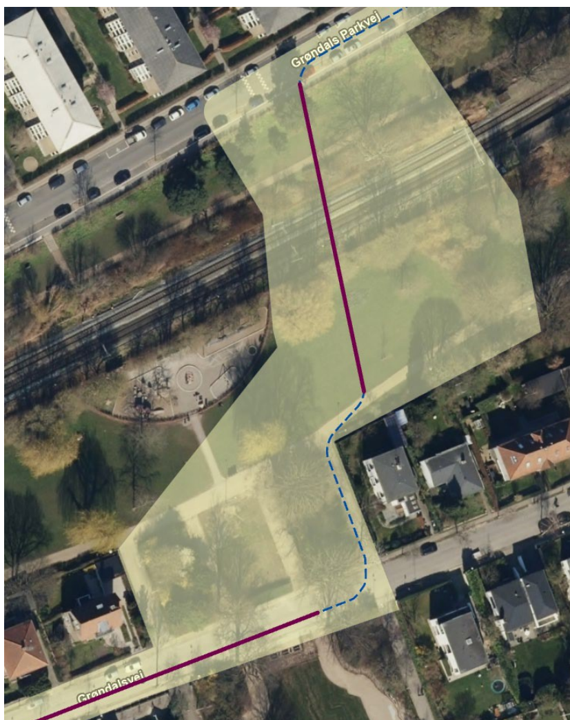
Figur 2 Kortudsnit med kabeltracé gennem Grøndalsparken. Lilla streg viser placering af underboring. Blå stiplede linje viser strækning med gravning. Gule flade viser projektområdet.
