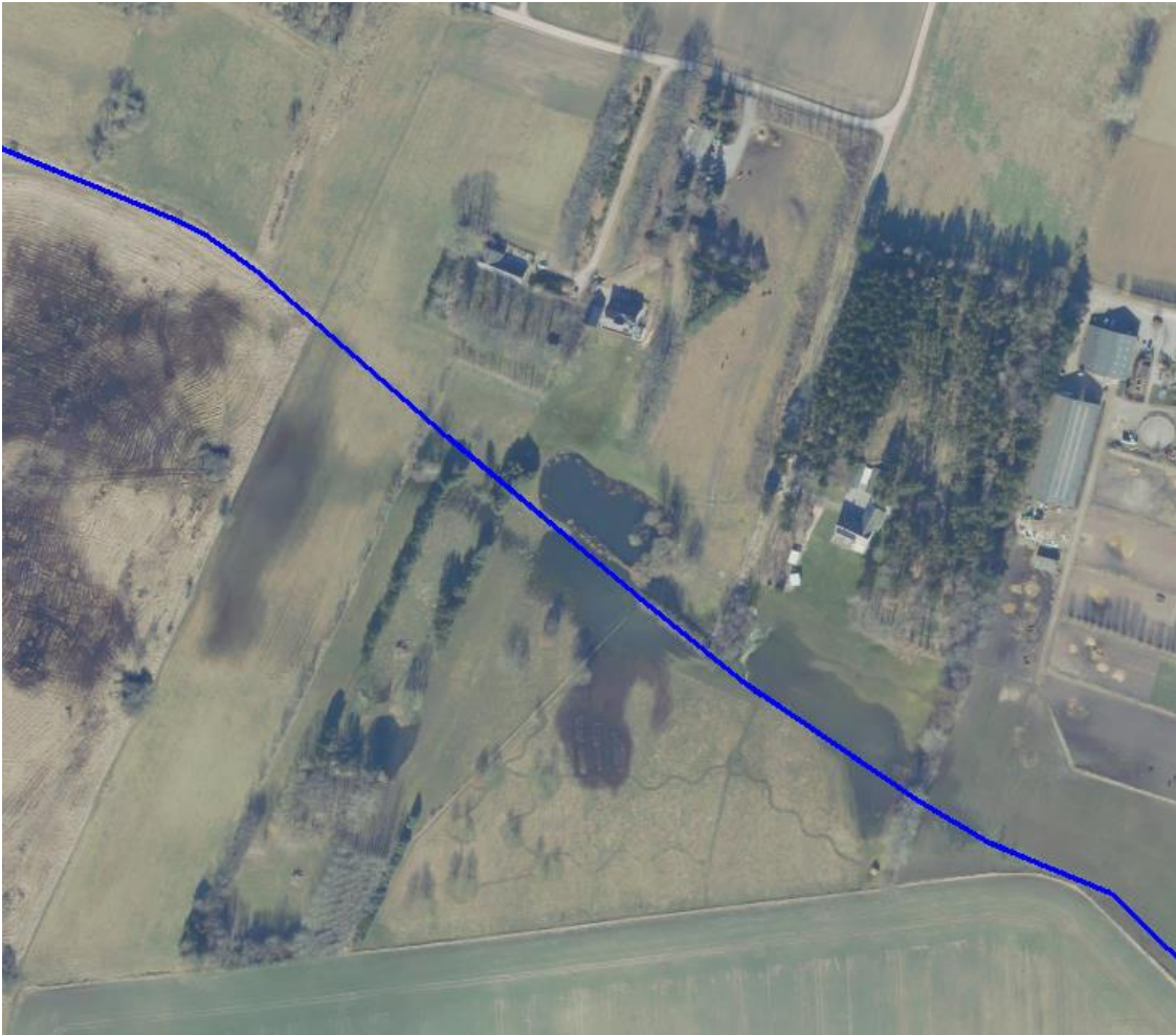
Figur 1.2 Rørlagt vandløb gennem den østlige del af projektområdet, hvor man kan se større områder der er oversvømmet. Luffoto er fra 2022.
