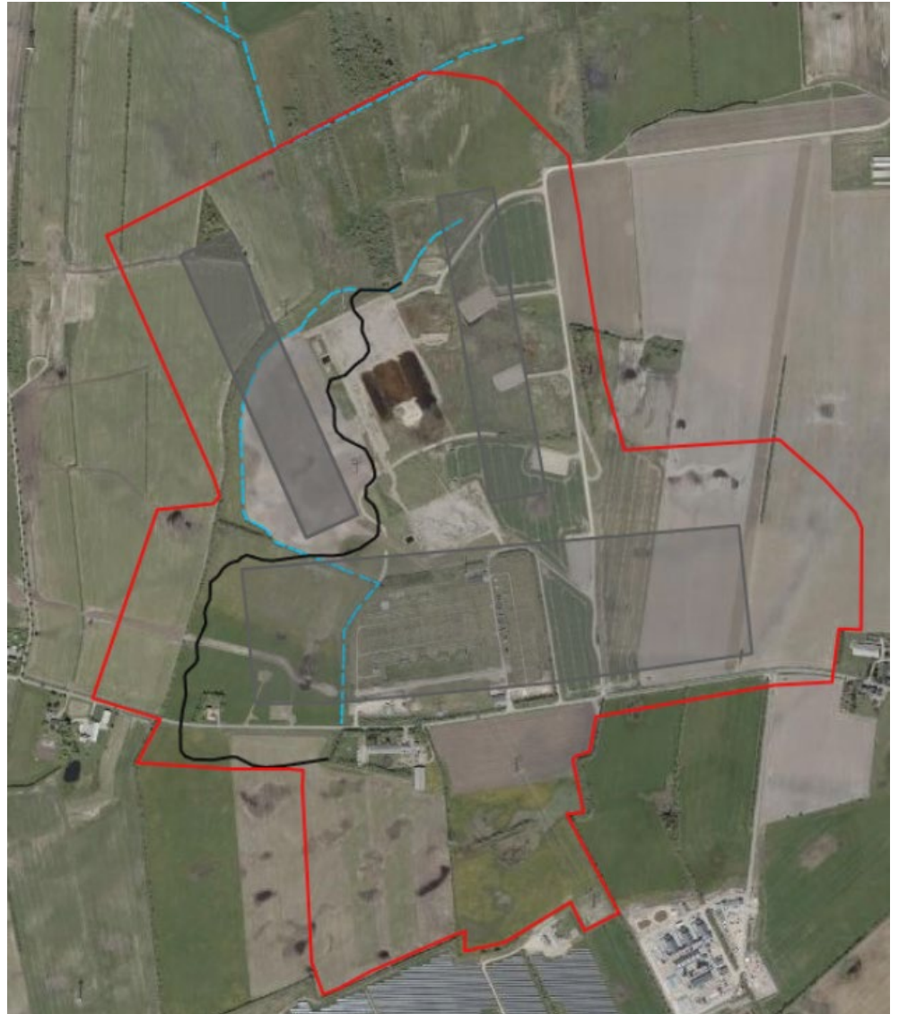
Figur 7: Oversigt over omlægningen af eksisterende vandløb. Blå streger = eksisterende vandløb, sort streg = omlagt vandløb
