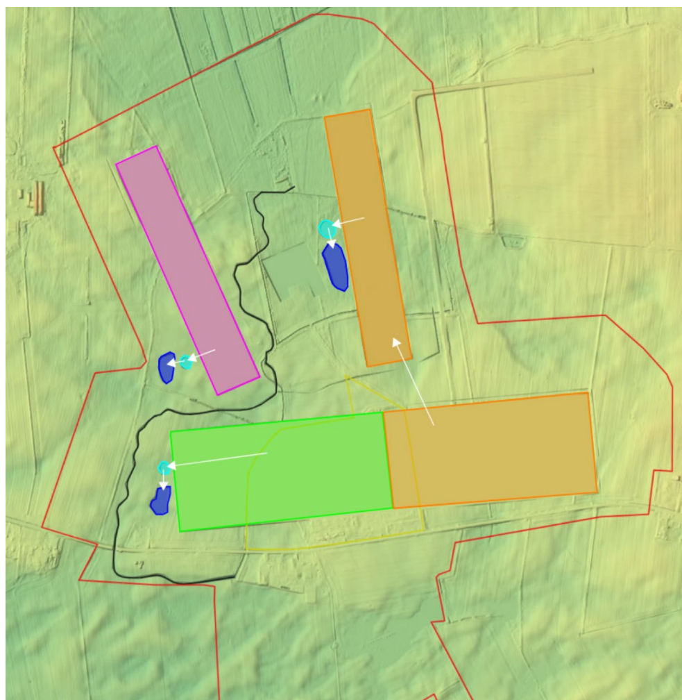
Figur 15: Oversigt over placering af bassinerne. Lyseblå cirkler = sedimentationsbassiner, mørkeblå cirkler = nedsivningsbassiner, sort streg = omlagt vandløb, hvide pile = hvilke områder, der ledes til bassinerne.
