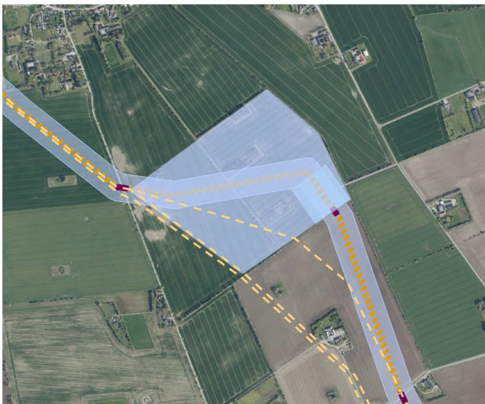
Figur 0-2. Kabeltracéet tilpasset stationsplacering. Det oprindelige forløb for KFII er vist med gul enkeltstiplet linje, mens den gule dobbeltstiplede linje viser tracéet for eksisterende KF.
