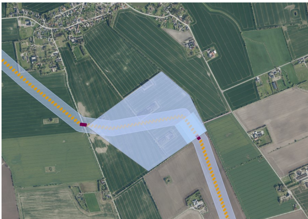
Figur 0-1. Placering af kompensationsstation (lyseblå firkant) inden for undersøgelsesområdet (gennemsigtig lyseblå). Vejadgang sker fra Vandringsvej (lyserød streg).
