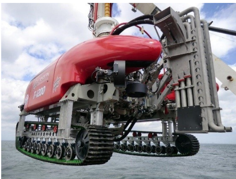
Figur 3-1: Eksempel på en moderne jetgraver T1200 (Primo Marine, 2022).
