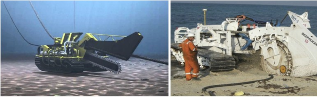
Figur 3-4: TV: Eksempel på mekanisk kædegraver (Primo Marine, 2022). TH: Eksempel på mekanisk hjulgraver (billede fra LDTO).
