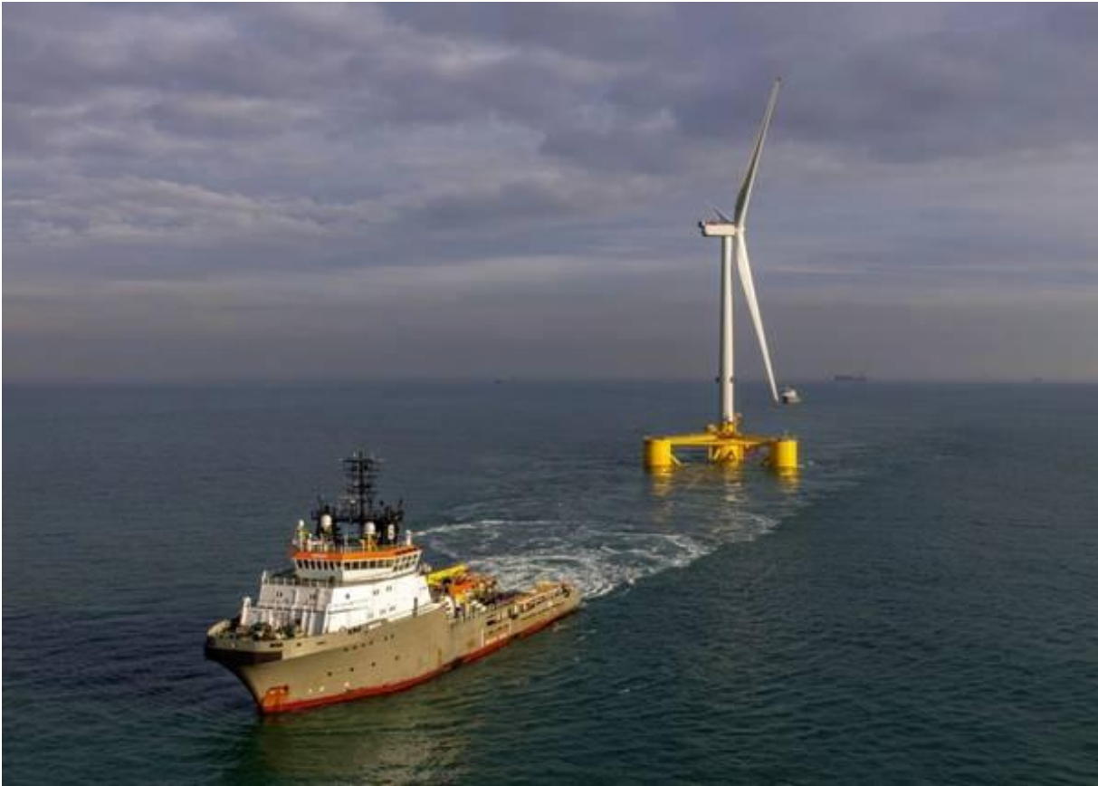
Figur 11. Bogsering av ett 9,5 MW vindkraftverk på semi-submersible fundament (Tomic 2020) (Foto Boskalis.).
