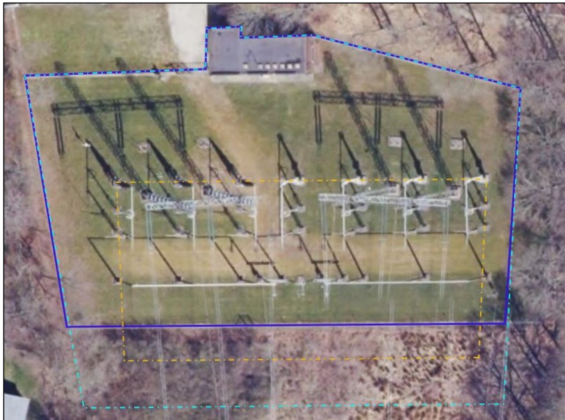
Figur 3-10. Skitse af kommende stationsareal. Eksisterende hegn (mørkeblå linje), kommende hegn (lyseblå stiplede linje) og placering af kommende nye felter (gul stiplede linje)
