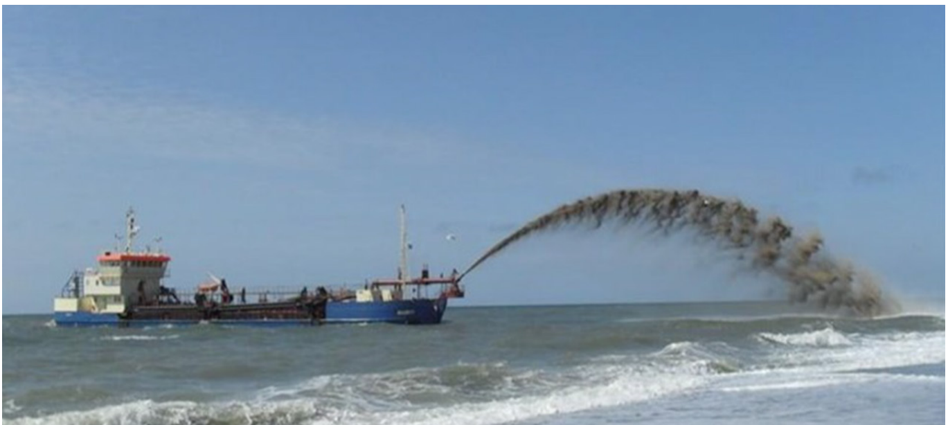
Figur 5. Sandfodring udført kystnært, med den såkaldte "Rainbowing" metode hvor sandet pumpes i en fane ud fra skibet.
