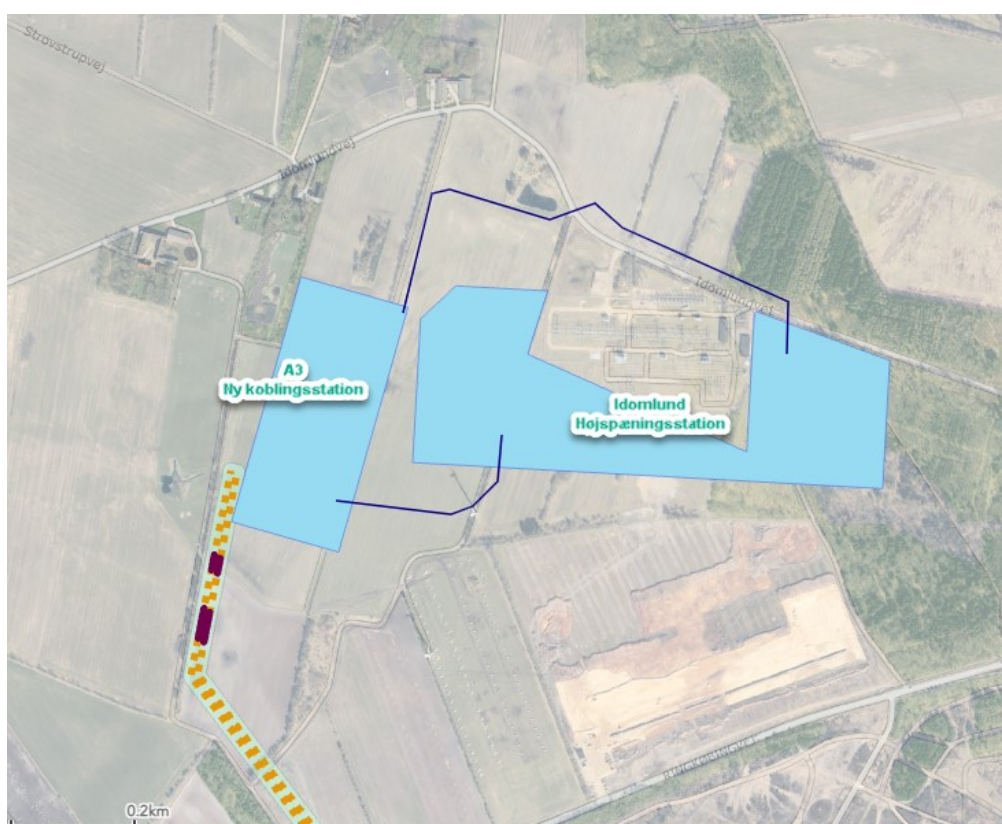
Figur 2 Projektændringer af linjeføringen af A3 ved Idomlund. De 2 blå linjer angiver den nye linjeføring mellem koblingsstationen og højspændingsstationen. Den gule linje viser linjeføringen for Nordsøen I A3 ind på koblingsstationen.
