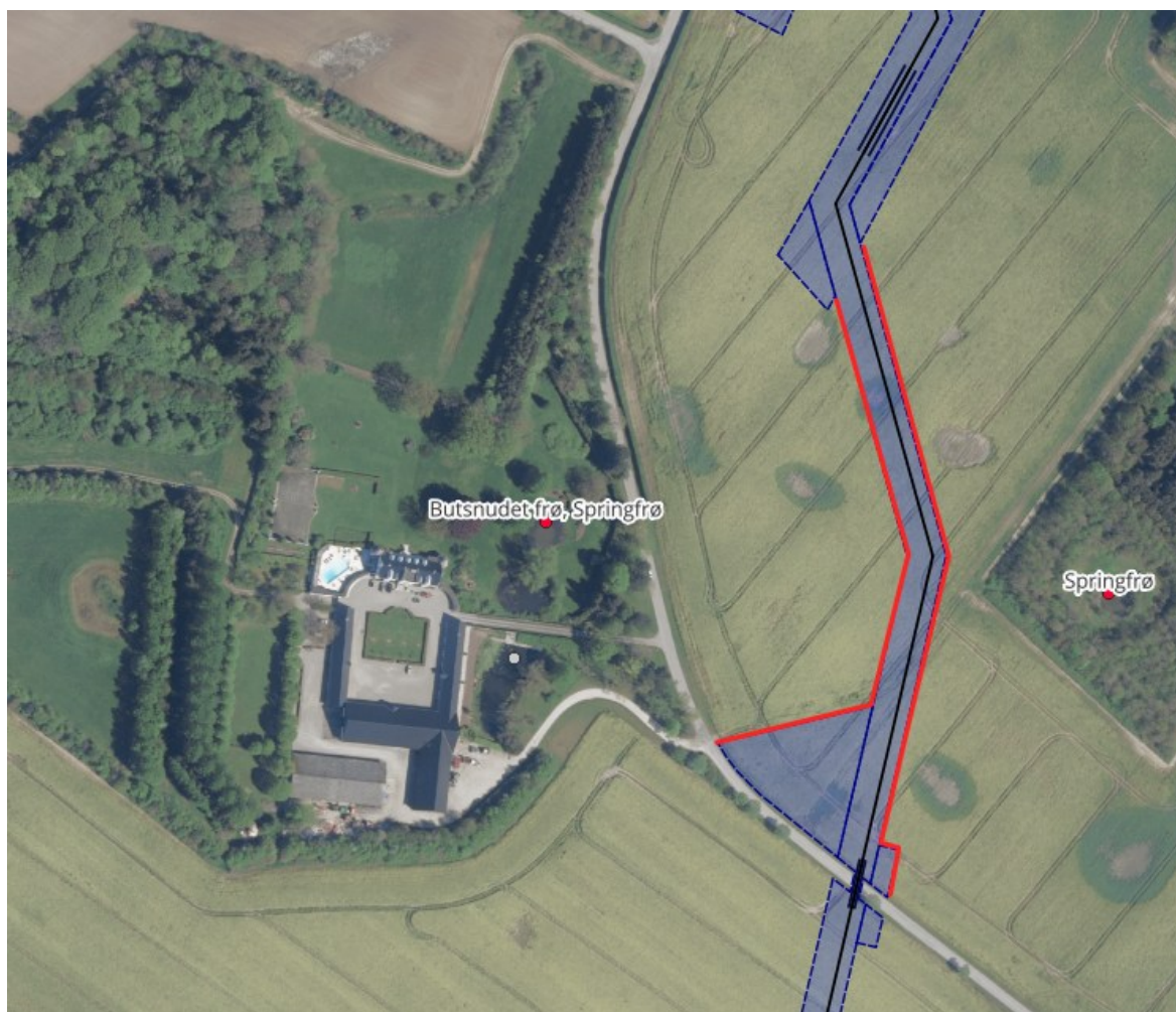
Figur 5: Eksempel på paddehegn med opsamling på ydersiden af arbejdsområdet. Arbejdsområdet inddrager ikke rasteområde for padder (dyrket mark). Der er registreret springfrø og butsnudet frø på begge sider af arbejdsarealet, så der vurderes at kunne forekomme en vandring mellem yngle- og rasteområder på tværs af kabeltracéet. Der er ikke oplagte ledelinjer for padderne, men de vurderes at kunne vandre på tværs af marken, da afstanden mellem de to paddeegnede områder (vildremise og have) er forholdsvis kort (ca. 150 m).
