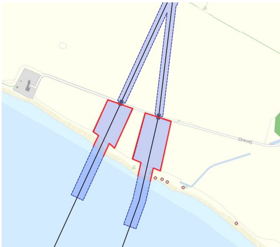
Figur 2: Arbejdsplads til etablering af kabel på Ore strand. Arbejdsområdet indhegnes med midlertidige paddehegn. Markfirben indsamles fra arbejdsområdet og genudsættes uden for paddehegnet, øst for kabeltracéet. Der skal etaleres to kabler, og derfor er arbejdsområdet opdelt i to. Vest for samt mellem de to arbejdsområder opsamles markfirben i nedgravede spande langs paddehegnet yderside, så længe arbejdsområdet er indhegnet. Markfirben indsamlet på denne måde udsættes øst for kabeltracéet. Hele kyststrækningen har egnede yngle- og rasteområder for markfirben, men området er bedst egnet mod øst, hvor der også er registreret flest markfirben.
