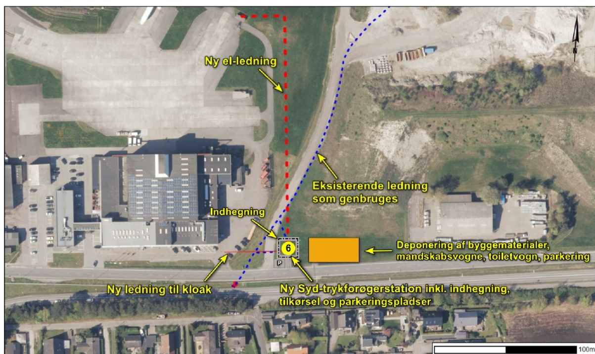
Figur 8. Oversigt over placering af Syd trykforøgerstation (delprojekt 6). Blå stiplede linje er eksisterende ledning, som tilsluttes HOFOR's forsyning (rød prik). Der etableres en ny elledning til eksisterende elskab (rød stiplede linje) og en ny kloakledning (rød streg). Kilde: bygherre.
