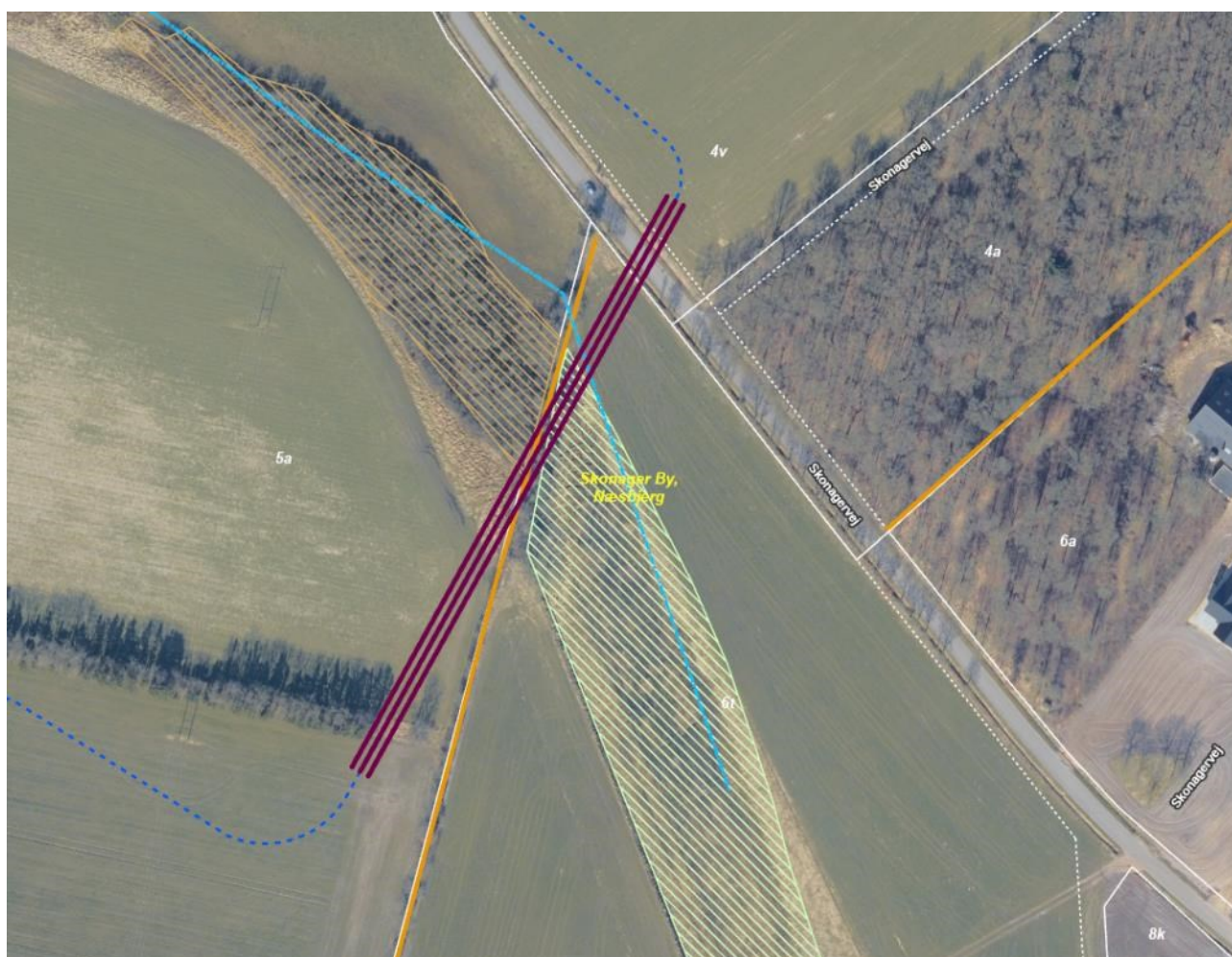
Figur 1-9. matr. 5a og 6t, Skonager By, Næsbjerg hvor der søges om dispensation til at føre kabeltracéet igennem beskyttet mose og beskyttet eng ved styret underboring.
