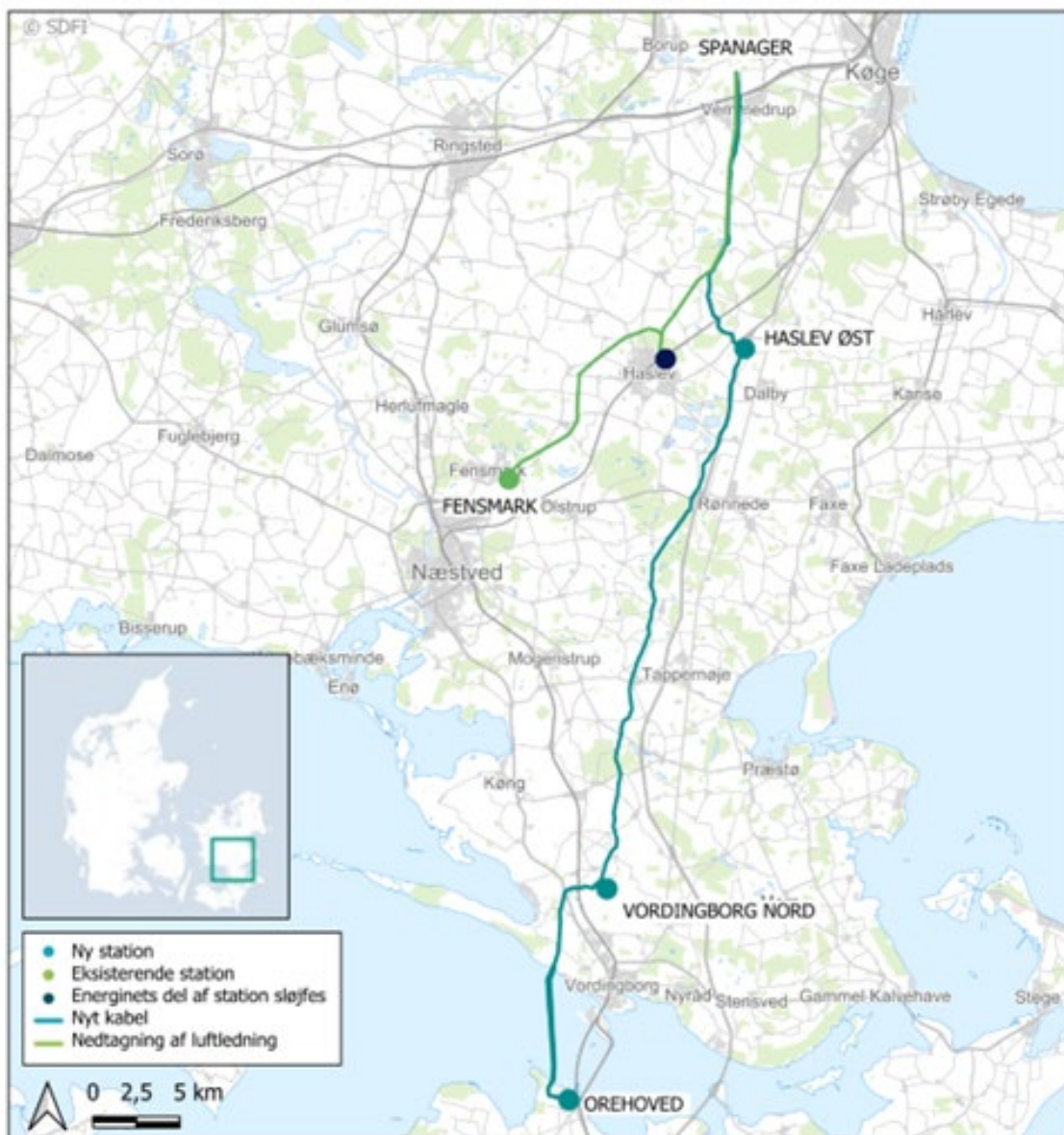
Figur 1 Oversigt over projektets udstrækning. Bemærk at kablet mellem Spanager og Haslev Øst etableres som et dobbeltracé.
