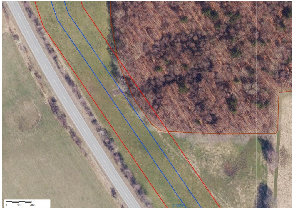
Figur 2-2 Arbejdsområdet (rødt) overlapper kun minimalt med moseområdet (KN010M) og den faktisk placering af kabler (blå) vil under detailprojektering kunne flyttes længere mod vest, hvorfor det vurderes at nedgravning af kabler kan foregå uden at påvirke tilstand af lokaliteten. Ligeledes forventes arbejdsområdet lokalt indsnævret, da der ellers vil skulle fældes træer og køres i våd natur. Ortofoto fra Danmarks Miljøportal.
