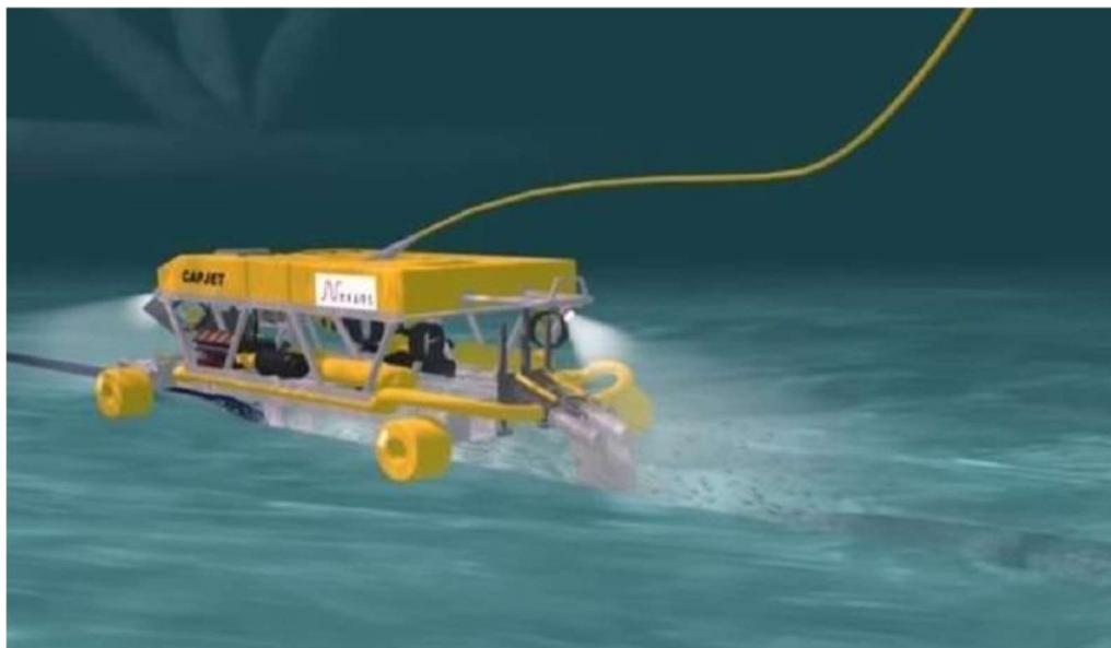
Figur 3.9: Illustration af princip ved anvendelse af spuleslæde til nedspuling af søkabel i havbunden.
