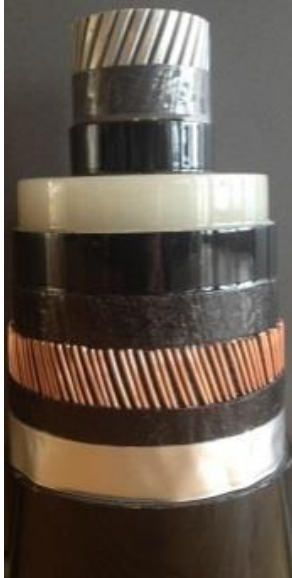
Eksempel på opbygning af 150 kV landkabel med komprimeret leder
