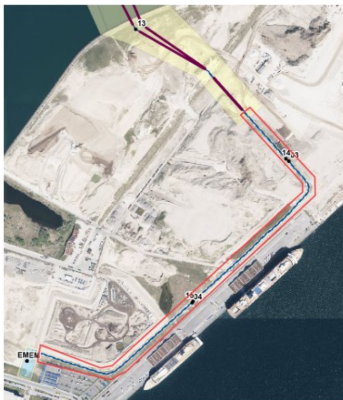
Figur 2 – Oversigt over hvor HK13040 GLN-OCE og HK13041 OCE-AMV kan spules i eksisterende føringsrør i Containervej på Ydre Nordhavn (rød kasse). Oversigten viser også hvor der sker under-boring mellem Containervej og ilandsføringspunkterne (lilla streger).
