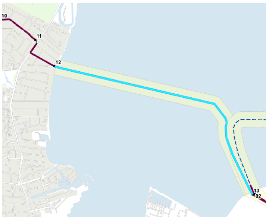
Figur 7 - Linjeføring for søkabel i kabelanlæg HK13040 GLN-OCE (lyseblå streg) Smat projektområdet (gul flade). Muffe 12 og 13 i hver ende af søkablet viser placeringen af overgangsmuffer (samling af land- og søkabel).
