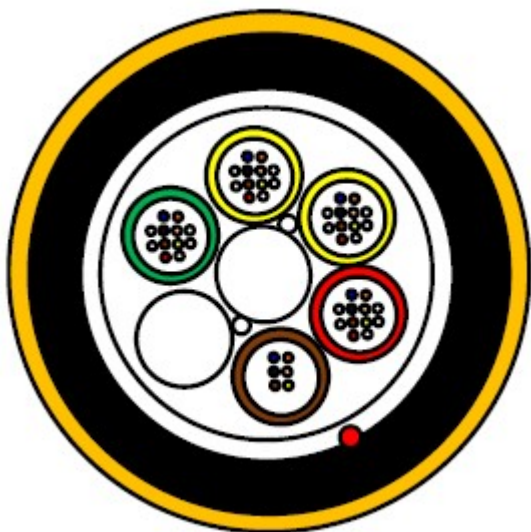
Figur 2-13: Tværsnit af fiberkabel til illustration af opbygning.
