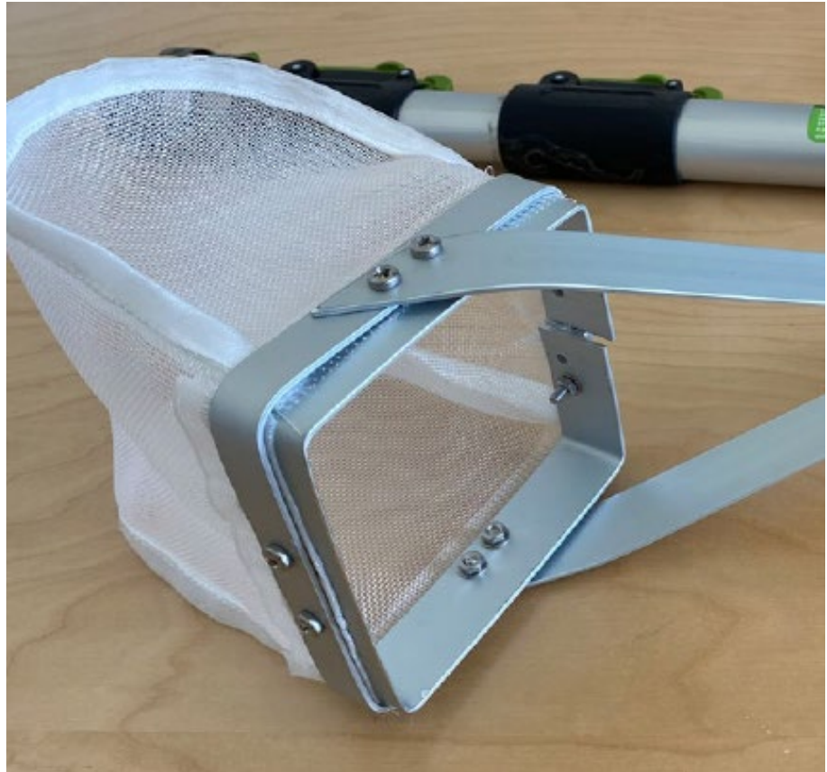
Figur 2.5. Skraber som anvendes i havnene til indsamling af skrabeprøver.
