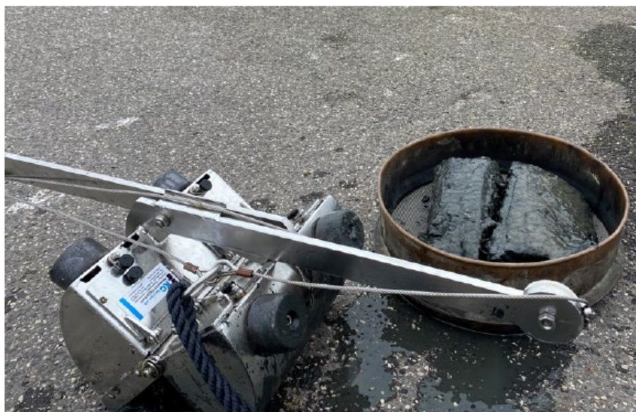
Figur 2.4. Håndholdt Van Veen grab og sigte anvendt i forbindelse med indsamling af bundprøver.
