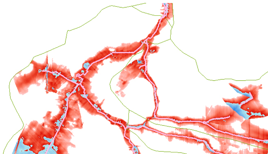
Figur 2.2. Eksempel på, hvordan lavtliggende områder omkring et vandløbssystem kan beskrives via GIS. Blå nuancer er niveauer under vandløbsniveauet, og røde nuancer er mellem 0 og 3 m over vandløbsniveauet. De mest mørkerøde farver er dér, hvor der er mindst højdeforskel i forhold til vandløbsbunden, og som dermed sammen med blå områder er de mest sandsynlige oversvømmelsesområder. Se også bilag 8.1.
