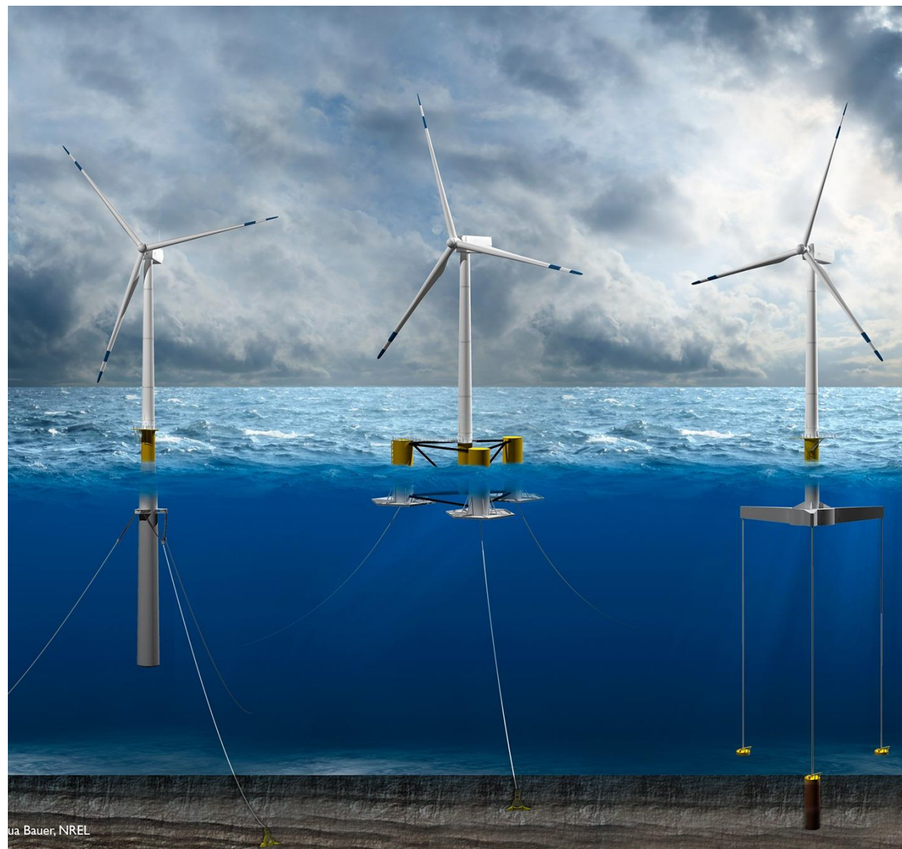
Figur 12. Exempel på flytande fundament som kan bli aktuella inom Skagerrak Offshore Gamma. Från vänster: Spar, Semi-Submersible, Tension leg. Illustration: Joshua Bauer, National Renewable Energy Laboratory (NREL).
