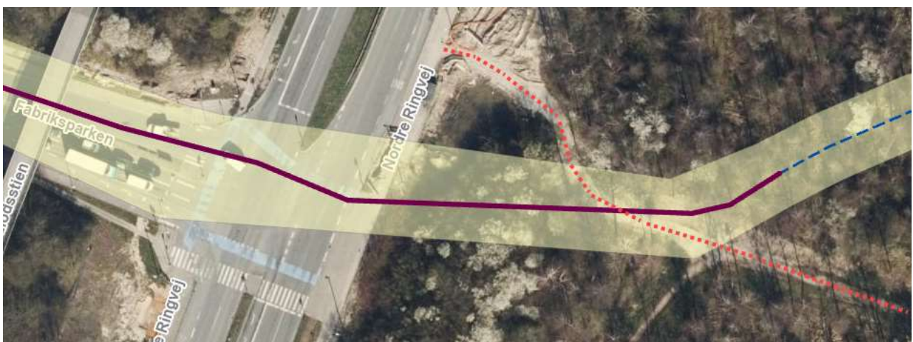
Figur 2-2: Kortudsnit af ledningstracé ved krydsning af Nordre Ringvej ind i Vestskoven. Underboring er vist med kørklilla strek. Kabelgrav er vist med blå stiplede strek. Rød prikket strek viser velbenyttet sti mellem boligområde og Nordre Ringvej.
