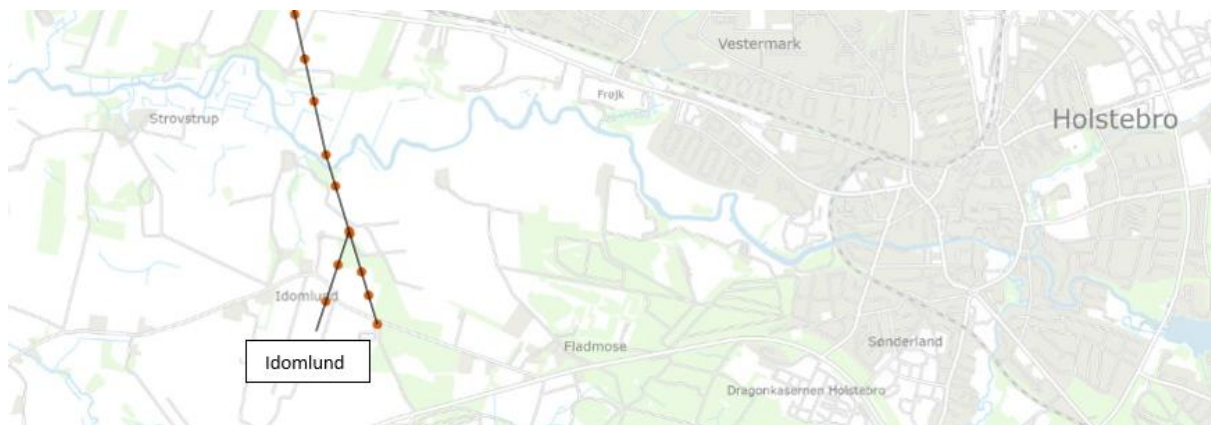
Figur 3 Der skal etableres en ca. 700 m ny luftledningsstrækning fra eksisterende luftledninger til Idomlund station (venstre ben på den sydlige strækning).
