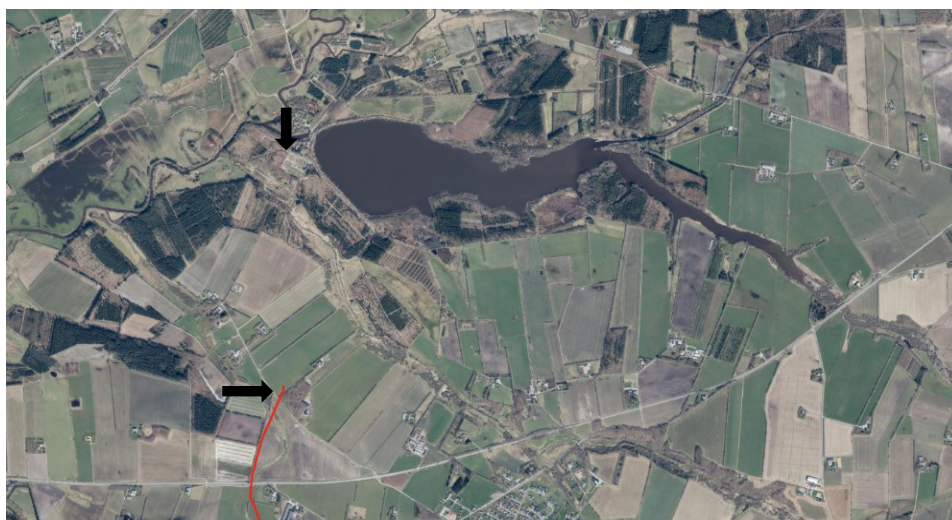
Figur 6 Den vandrette pil er Skonager jordkabel. Den lodrette pil er ved Karlsgårde højspændingsstation
