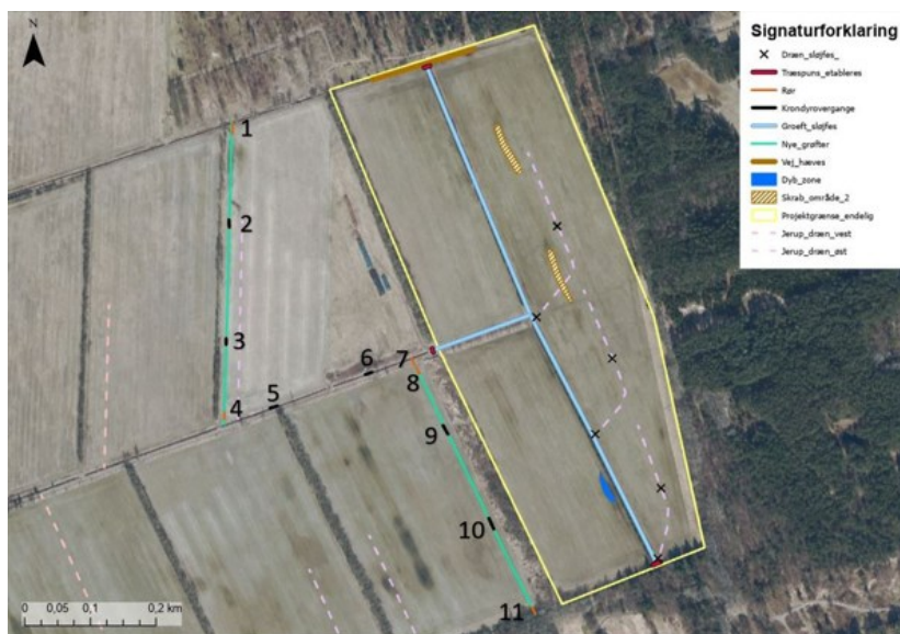
Figur 2-6. Placering af de 5 rørbroer og 6 krondyr overgange i de to nye grøfter nr. 9 og 10 samt nummerering. Fra bilag 1.2, detailprojekt, figur 3-6.
