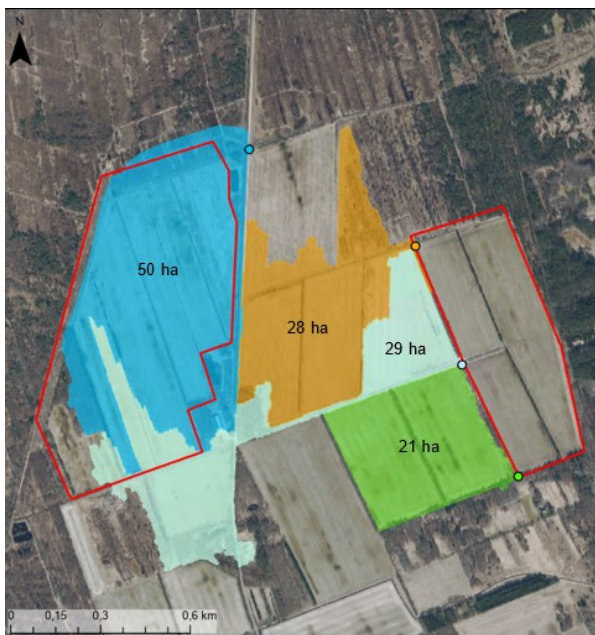
Figur 2-5. Topografiske oplande angivet med farve og hektar til udvalgte afløbsplaceringer (punkter) ved projektområdet (rød afgrænsning). Fra bilag 1.2 Detailprojekt, figur 2-9.
