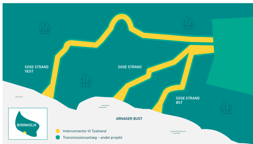
Figur 2: Placering på land af Energiø Bornholm Interconnector til Tyskland i forhold til transmissionsanlægget på Bornholm; de ansøgte projektområder til landkabler for de to projekter er de samme.
