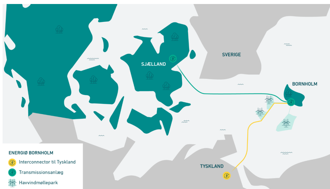
Figur 1: Placering af Energiø Bornholm, der består af tre dele: en havvindmøllepark, et transmissionsanlæg med højspændingsstationer på Bornholm og Sjælland forbundet med en kabelforbindelse, samt en udlandsforbindelse (en 'interconnector') fra Bornholm til en station i Tyskland. Denne afgrænsningsudtalelse vedrører alene projektet Energiø Bornholm Interconnector til Tyskland, dvs. den del af udlandsforbindelsen, som ligger i Danmark.
